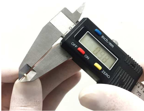
Figura. 17: Área transversal dos palitos sendo mensurada com paquímetro digital.
