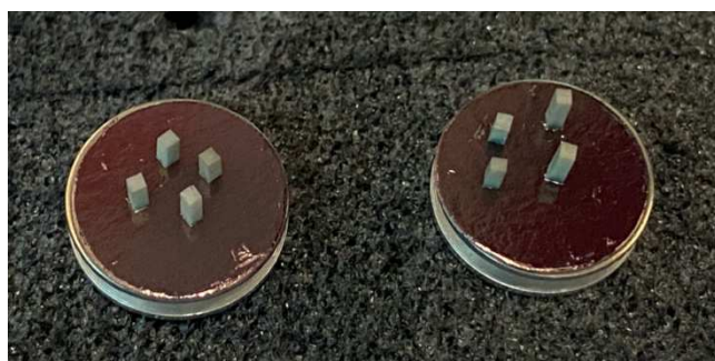
Figura 21. As amostras metalizadas montadas em stubs de alumínio.
