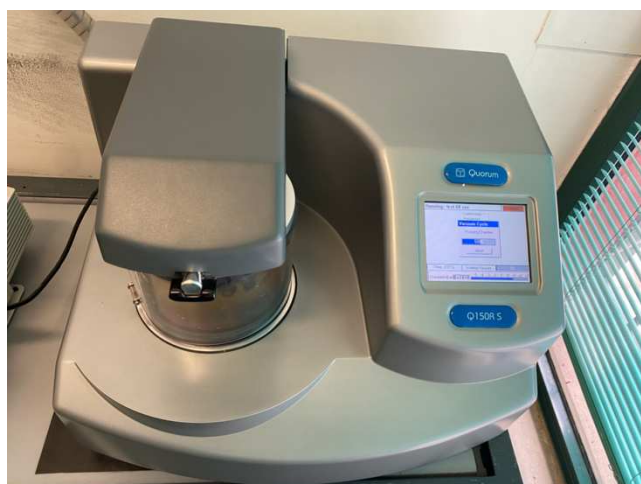
Figura 20. As amostras sendo revestida com ouro no “sputtering device”.
