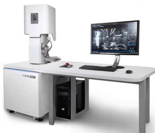
Figura 22. Microscópio de varredura usado para obter as imagens da modalidade de falha dos espécimes (Feg-SEM, Mira3 Tescan, Brno, Czech Republic).
