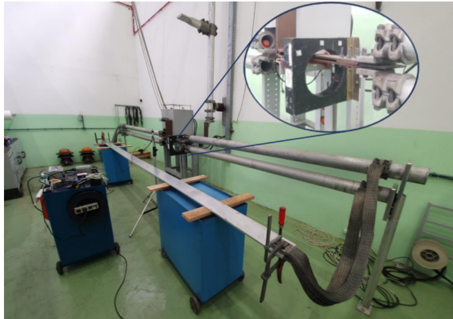
Figura 23 – Sistema de aquecimento.
