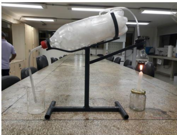
Figura 2 - Destilador alternativo proposto por Matias e colaboradores (2018).
