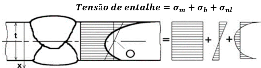
Figura 28 – Distribuição de tensões ao redor da solda.
