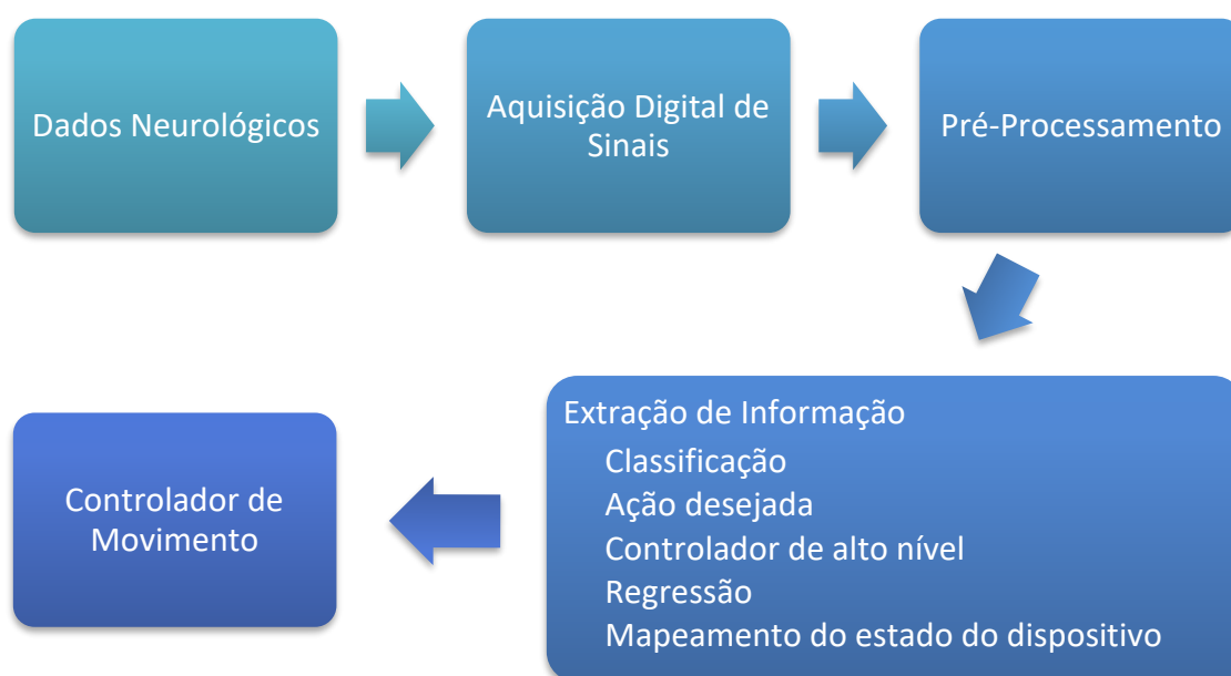
Figura 8 - Fluxograma de decodificação de biosinais corpóreos para processamento e ações através de Inteligência Artificial para processamento e ação em pacientes
