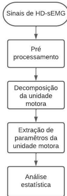
Figura 27 – Fluxograma da metodologia de processamento e classificação dos sinais de HD-sEMG.
