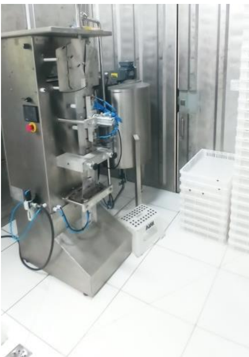
Figura 2 –Máquina de Envase que automaticamente preenche a embalagem da polpa
