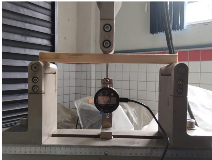
Figura 4 – Ensaio de flexão estática na Máquina Universal de Ensaio Mecânicos.
