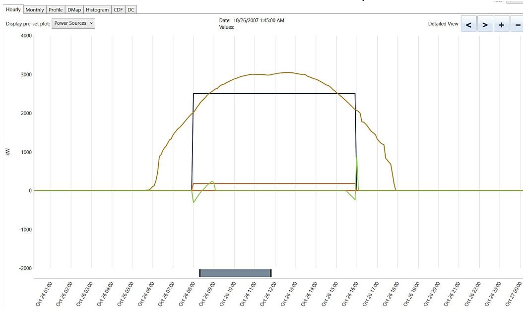
FIGURA 23 – Funcionamento diário da Microrrede para a Fazenda C
