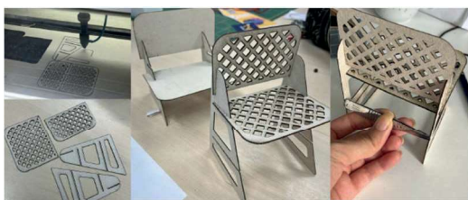
Figura 7: Corte a laser em papel Paraná (2º teste). Fonte: elaborado pelos autores.
