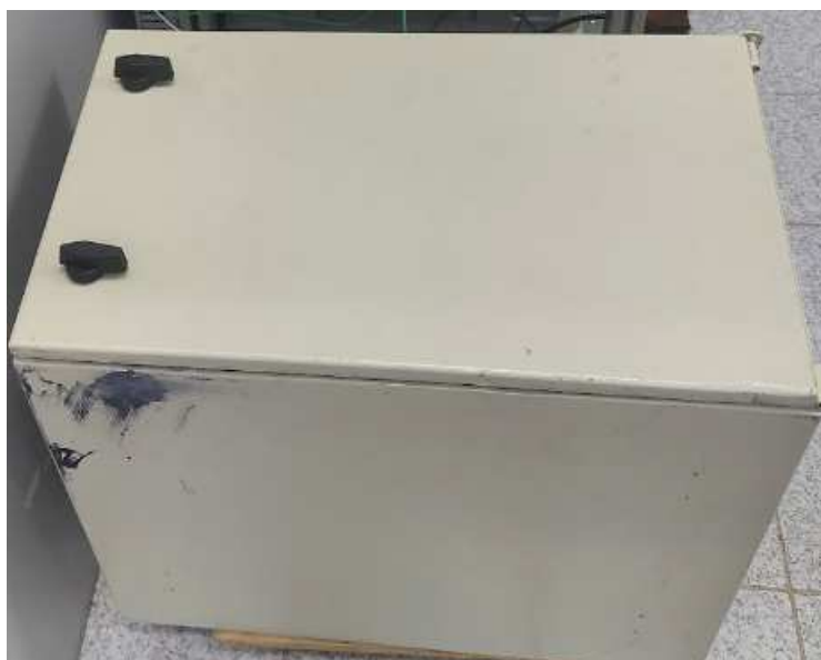
Figura 12 – Caixa de equalização utilizada para construção da estufa térmica.
