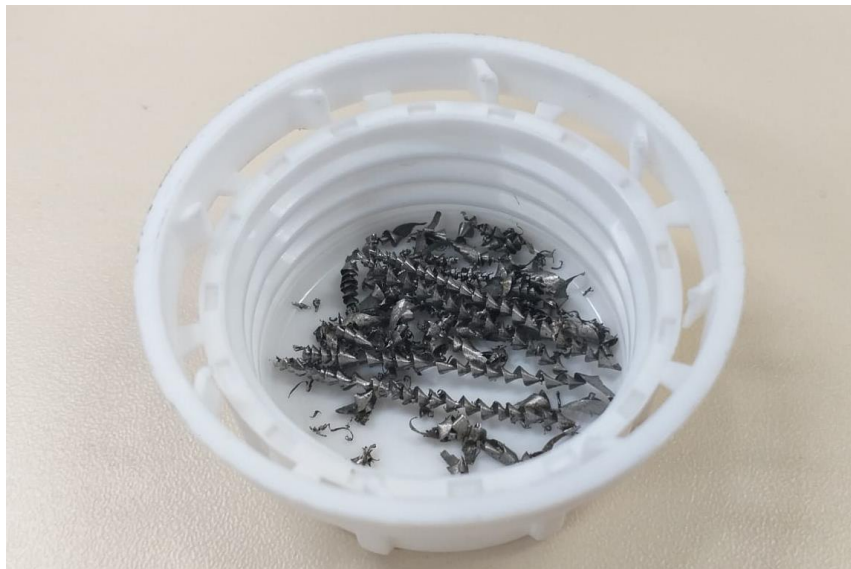
Figura 23 - Amostra de material da sobre-mesa de prensa de estampagem
