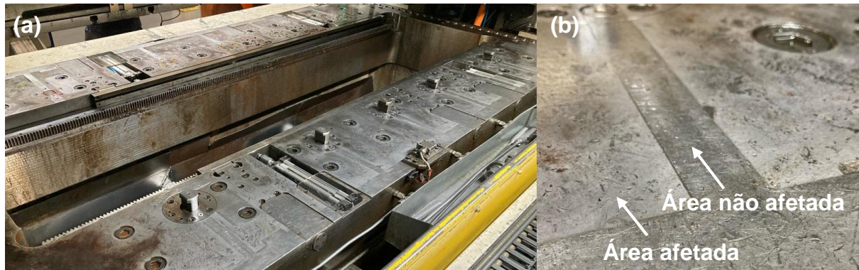
Figura 21 - Mesa da prensa (a) e variações dimensionais na mesa (b)
