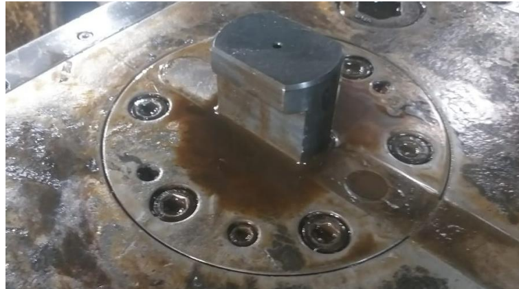
Figura 25 - Região de coleta do óleo para verificação da existência de partículas ferromagnéticas.
