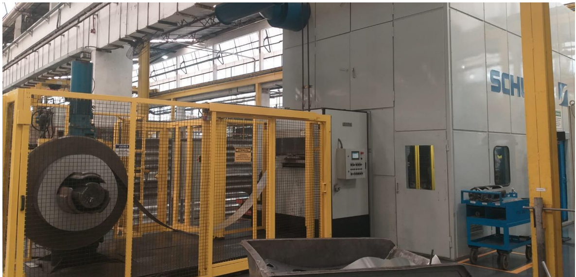
Figura 6 - Prensa de estampagem progressiva Schuler E-30.
