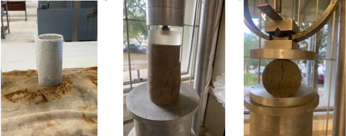
Figura 32 - Corpos-de-prova após submersão, ensaio de compressão simples e compressão diametral.
