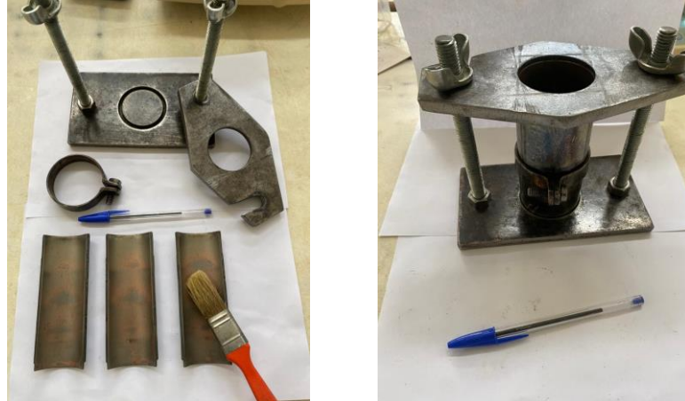
Figura 28 - Preparação do molde metálico para o ensaio de compactação.
