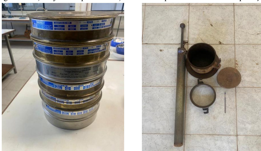
Figura 20 - a) conjunto de peneiras e b) cilindro e soquetes do ensaio de compactação.
