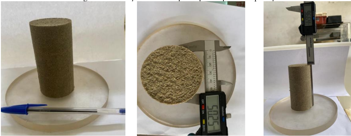
Figura 30 - Medições de um corpo-de-prova após a compactação.
