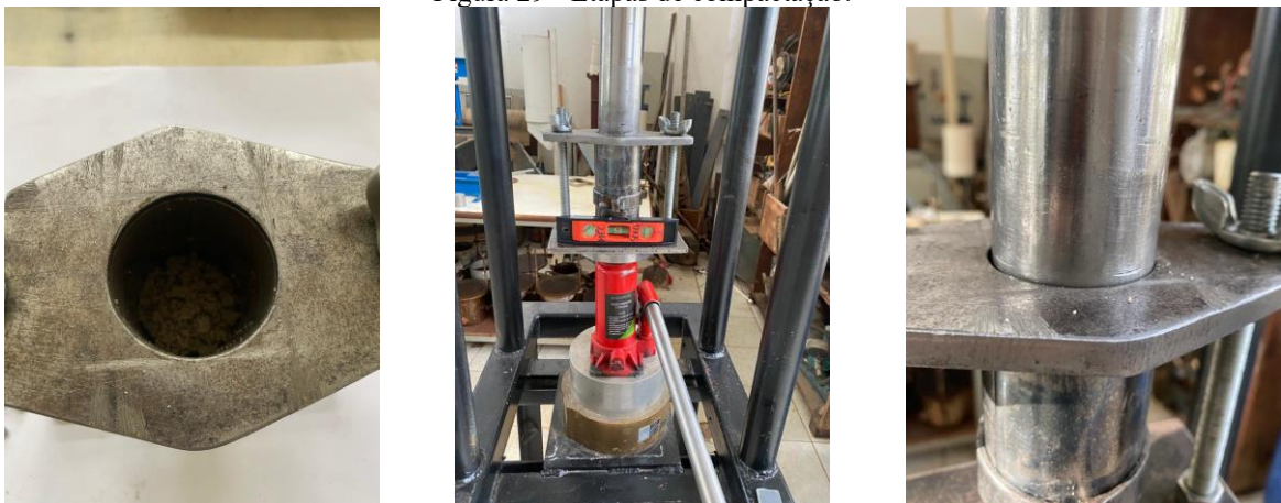
Figura 29 - Etapas de compactação.
