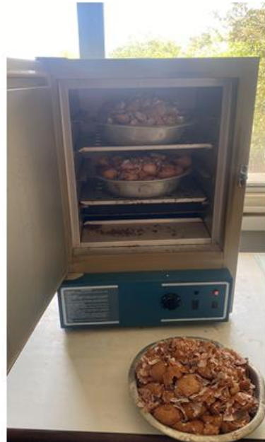
Figura 14 - a) Tubo de PVC para a limpeza das cascas de ovo, b) Secagem das cascas em estufa.
