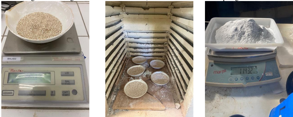
Figura 18 - Pesagem de casca de ovo moída, cascas dentro do forno e a pesagem da cinza.
