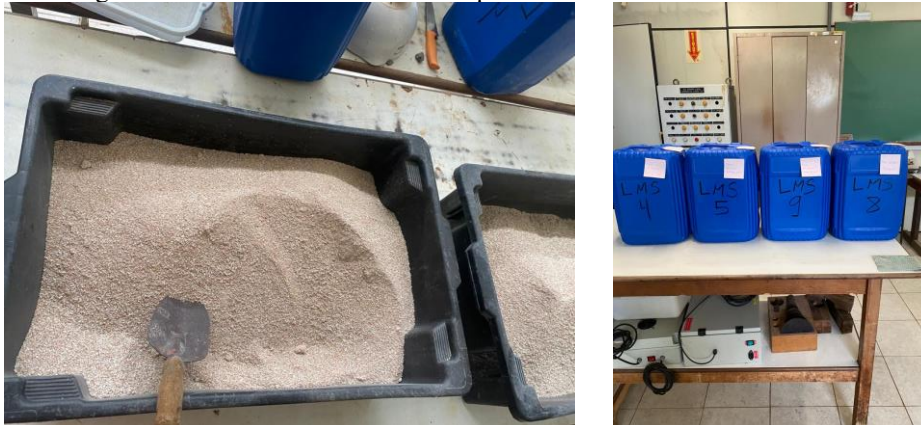
Figura 17 - Processo de mistura e de quarteamento da casca de ovo moída.
