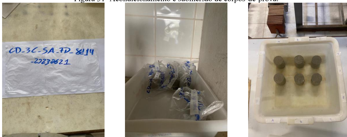
Figura 31- Acondicionamento e submersão de corpos-de-prova.
