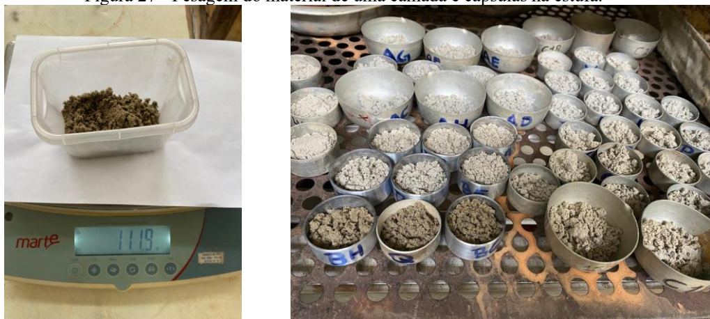
Figura 27 - Pesagem do material de uma camada e cápsulas na estufa.
