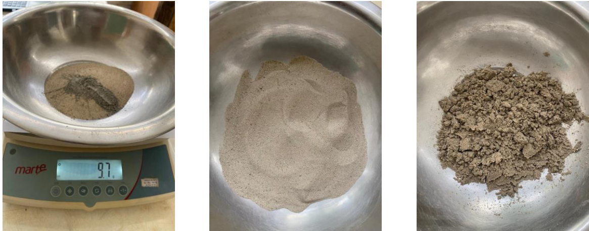
Figura 26 - Processo de pesagem e mistura do solo, cimento e água.
