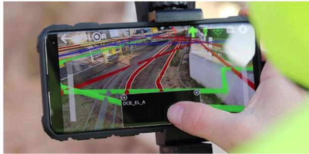
Figura 18 - Exemplo de aplicativo de RA utilizado pela empresa Colas
