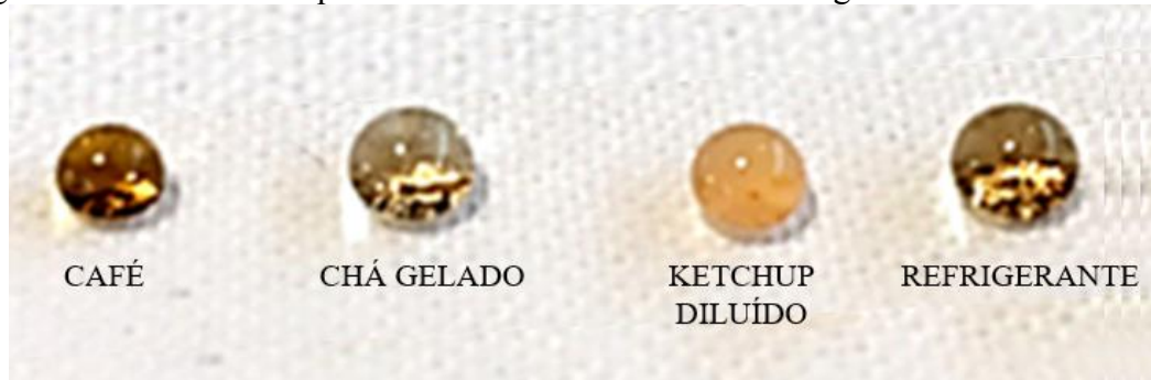
Figura 15 – Diferentes líquidos em contato com o tecido de algodão tratado com NaOH.
