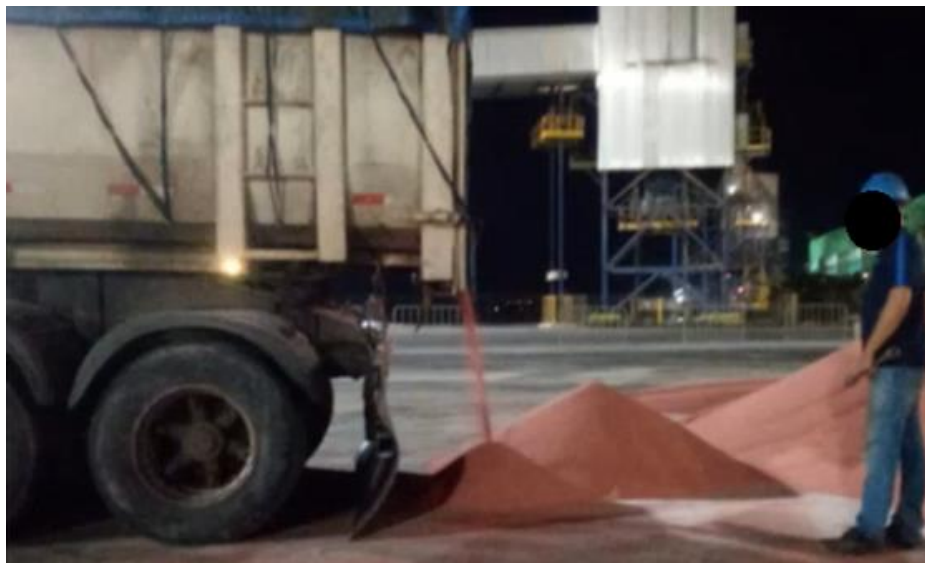
Figura 25: Risco ao trabalhador na atividade de alívio de carga.
