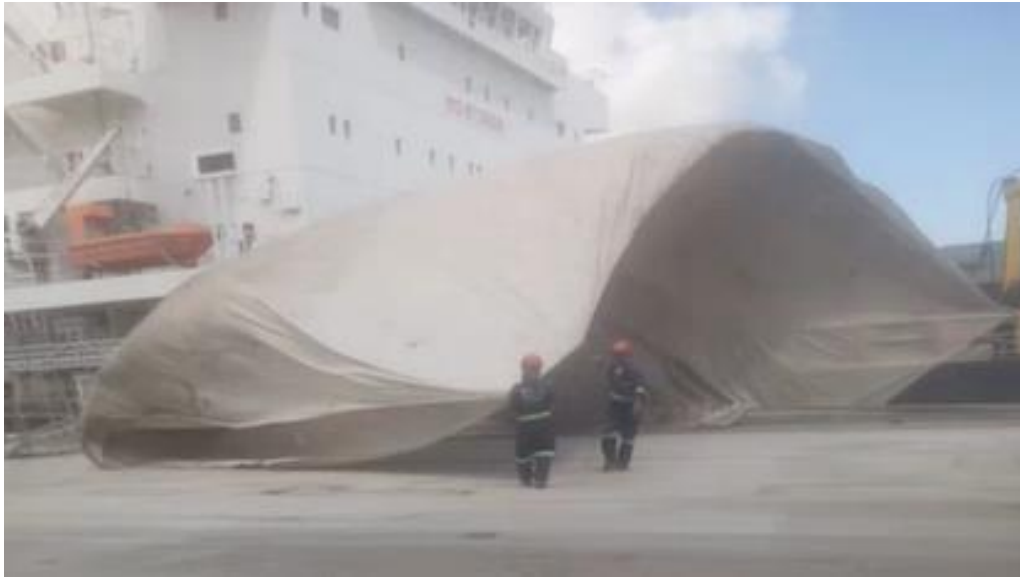
Figura 24: Risco ao trabalhador na instalação da lona de costado
