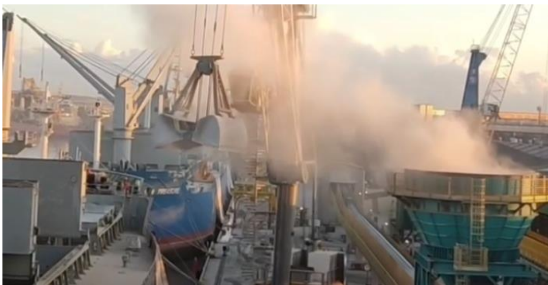
Figura 8: Material particulado disperso no ar após derramamento no funil
