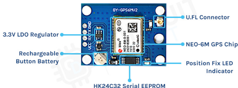
Figura 8 – Visão geral de uma placa de desenvolvimento GNSS comum que utiliza o módulo NEO-6M da empresa U-blox.
