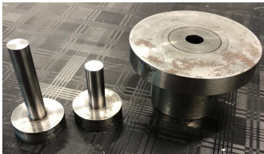
Figura 14 - Equipamento utilizado para compactação dos pós.
