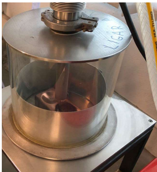
Figura 16 – Câmara de fusão do forno a arco voltaico.
