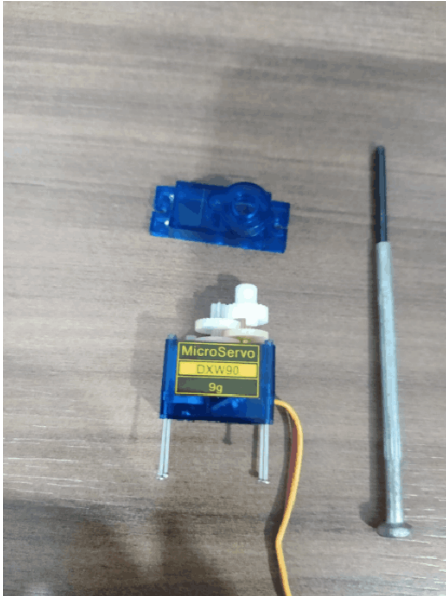
Figura 8 – Adaptação mecânica no servo-motor
