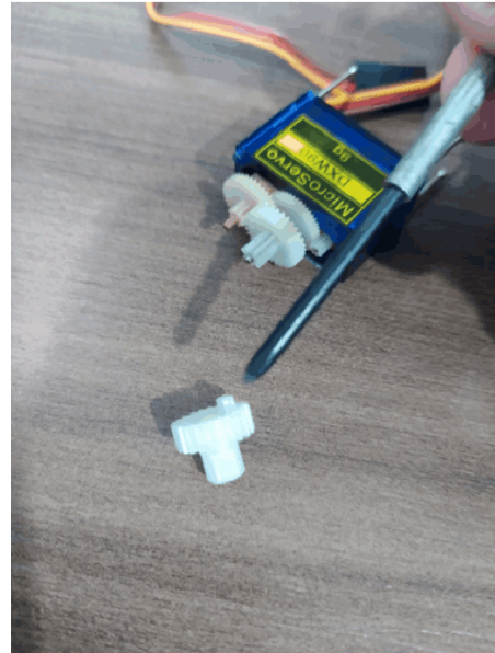
Figura 8 – Adaptação mecânica no servo-motor
