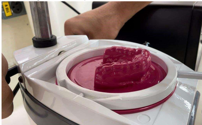
Figura 7 - Prensagem de uma placa de EVA de maior espessura (3mm)
