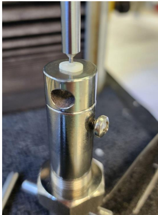
Figura 3 – Posição da amostra para a realização do ensaio de resistência de união na máquina de ensaio universal Instron, Modelo 4444.
