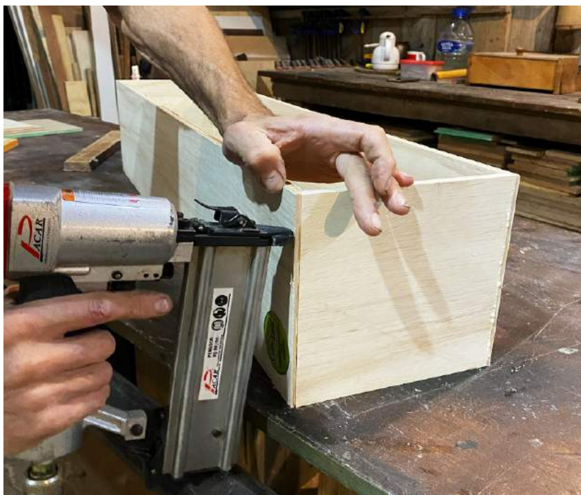
Figura 168 – Pistola de pressão sendo utilizada para pregar módulo de armazenamento 3
