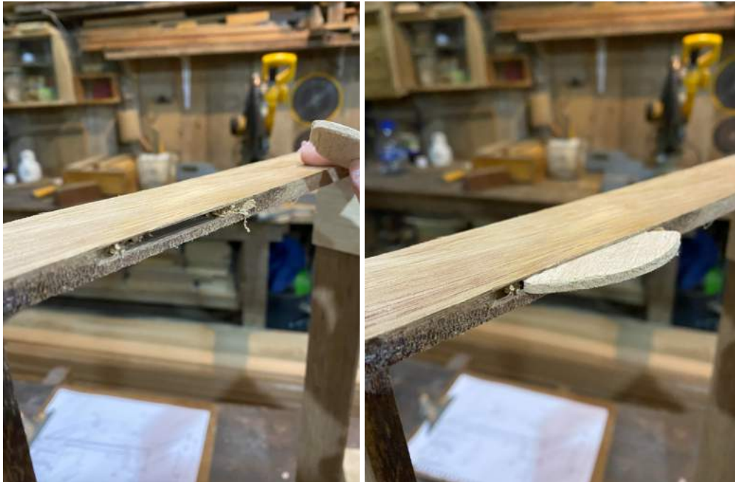
Figura 161 – Encaixes com biscoito para fresadora de junção
