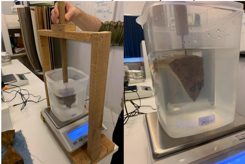
Figura 4 – Método de determinação do volume pela balança hidrostática.
