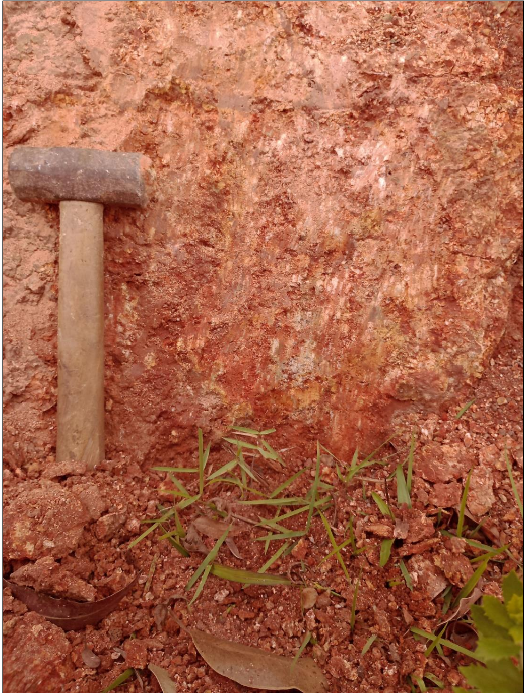
Figura 22. Solo de textura argilosa e cor vermelho-amarela, ainda preservando a estrutura da rocha mãe. Podem-se observar alguns minerais de cor branca (caulinita), fruto do intemperismo dos feldspatos.
