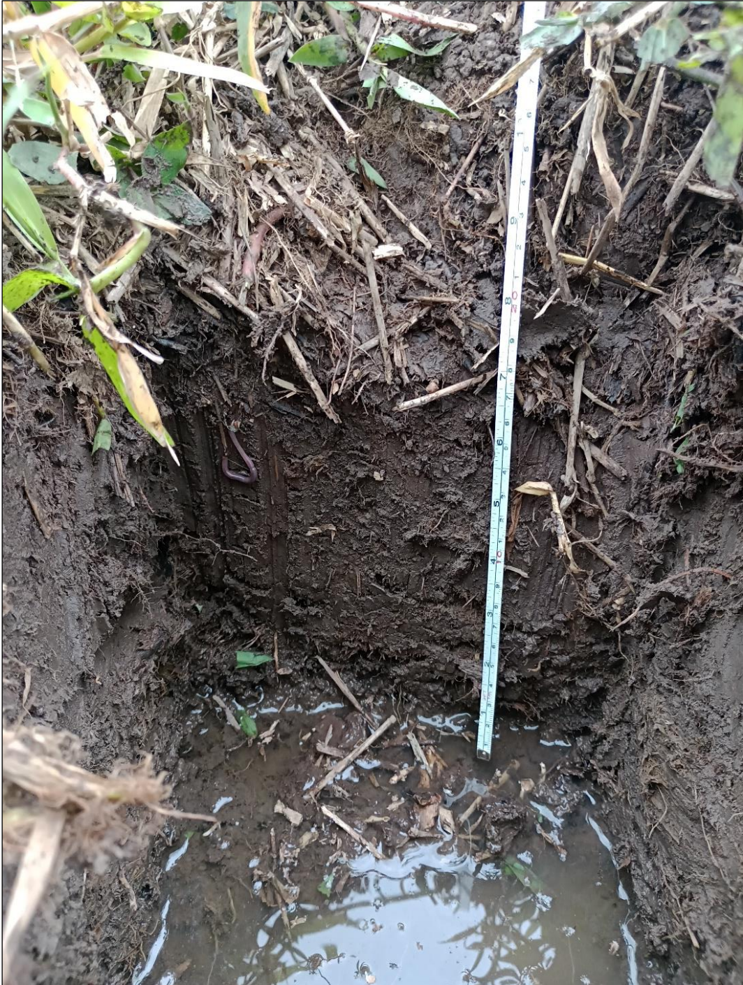
Figura 29. Organossolo de textura siltosa, rico em matéria orgânica em ambiente mal drenado.
