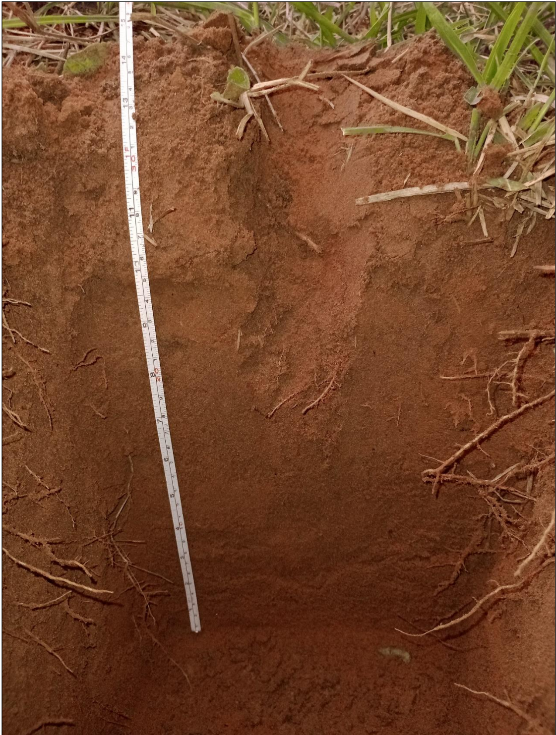
Figura 28. Textura essencialmente arenosa com presença de matéria orgânica.
