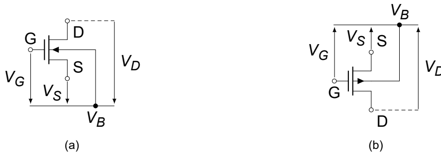
Figura 5 – Símbolos de quatro terminais dos dispositivos (a) NMOS e (b) PMOS e as definições das tensões.
