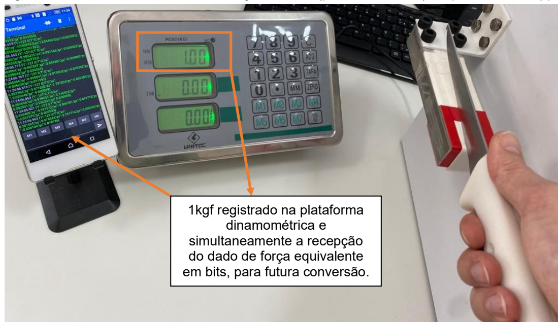
Figura 1 – Conferindo valores de calibração da faca (próximo ao cabo) via plataforma e App
