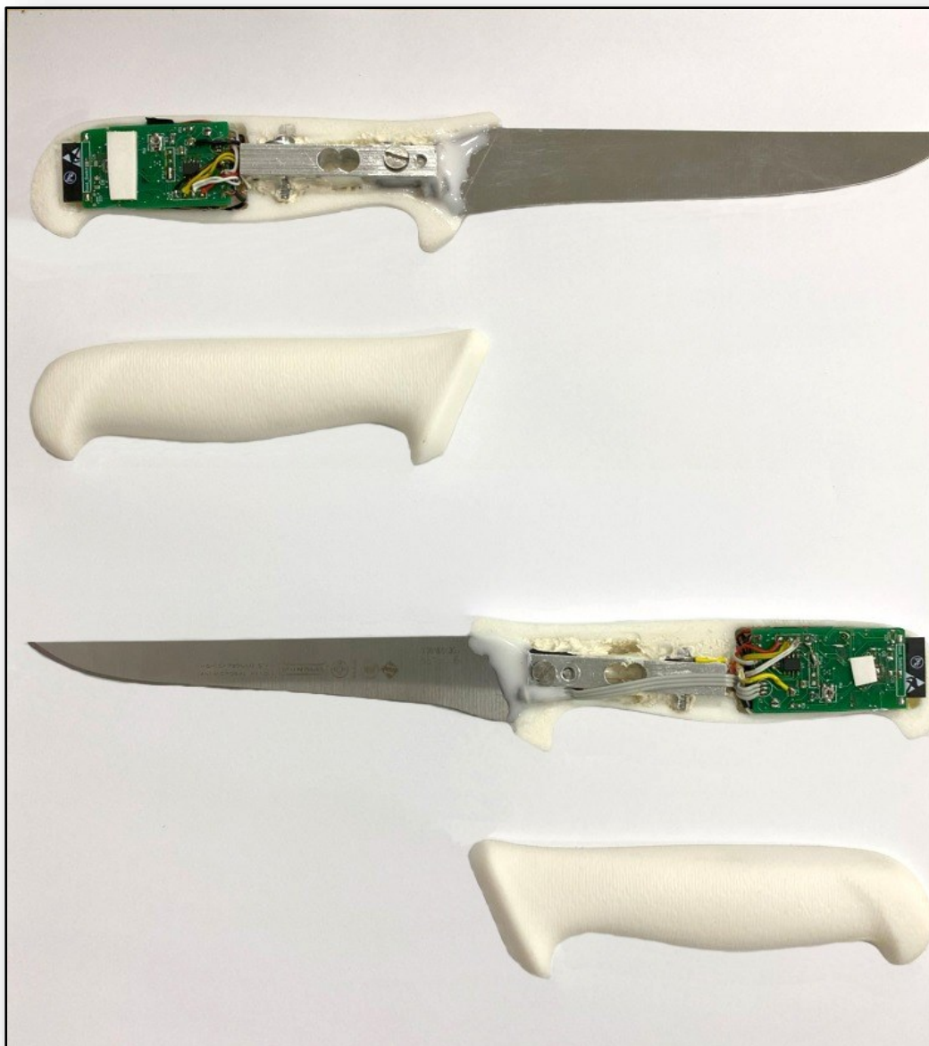
Figura 12 – Facas instrumentadas e prontas para o fechamento do cabo
