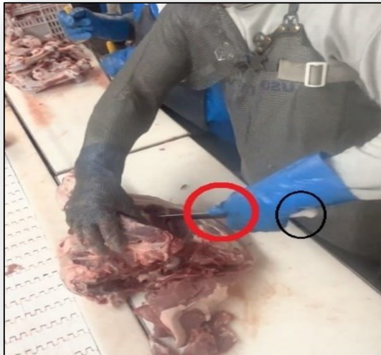
Figura 26 – Uso incorreto da faca e a anulação da força aplicada ao cabo
