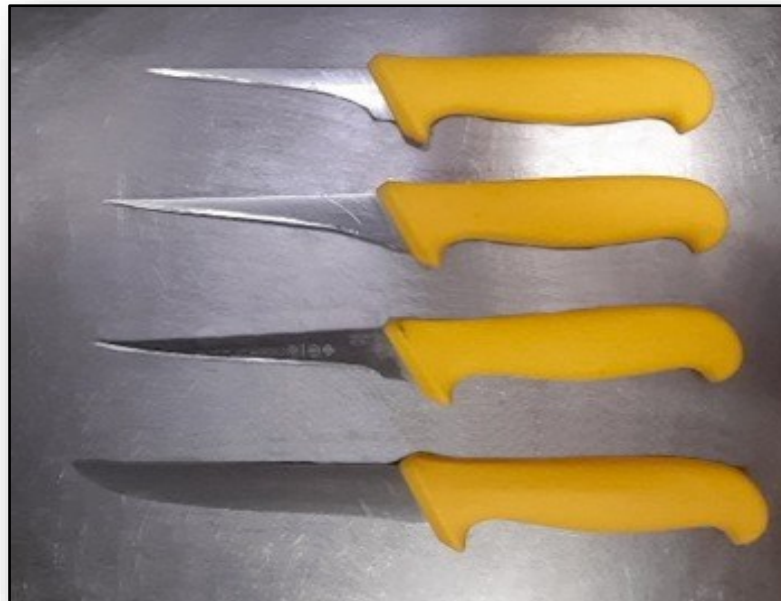
Figura 17 – Processo de desgaste NATURAL da faca pelo uso
