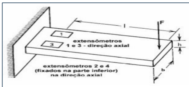
Figura 3 – Transdutor do tipo lâmina engastada
