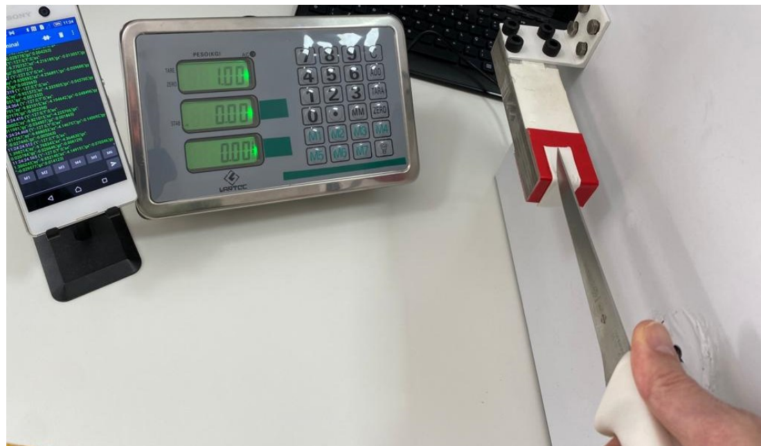
Figura 2 – Conferindo valores de calibração da faca (próximo a ponta da lâmina)
