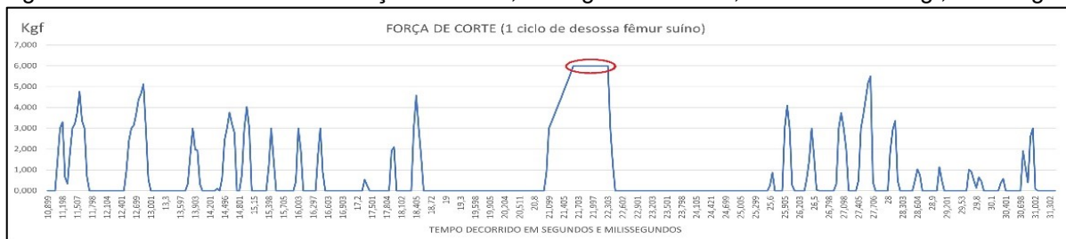
Figura 24 – Gráfico da coleta de força com valor, em algum momento, saturado em 6 Kg, faca larga
