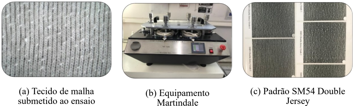
Figura 32 - Apresentação de (a) corpo de prova submetido ao teste de formação de pilling, (b) equipamento utilizado e (c) o padrão fotográfico empregado nos ensaios
