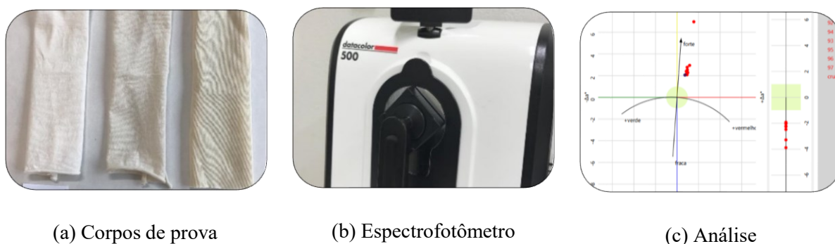
Figura 31 - Apresentação de (a) diferentes graus de branco, (b) espectrofotômetro utilizado e (c) apresentação das respostas lidas no software do espectrofotômetro
