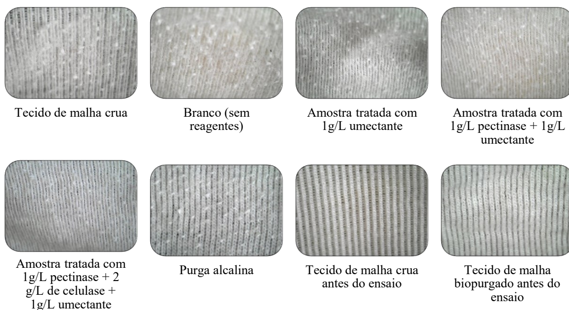
Figura 41 - Teste de formação de pilling nas amostras beneficiadas, comparadas com as malhas sem o tratamento
