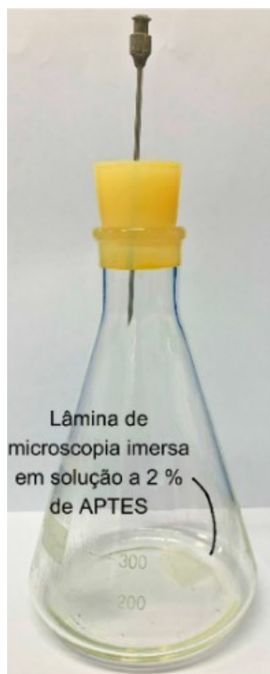
Figura 14 – Erlenmeyer contendo a lâmina de microscopia com solução a 2% de APTES
