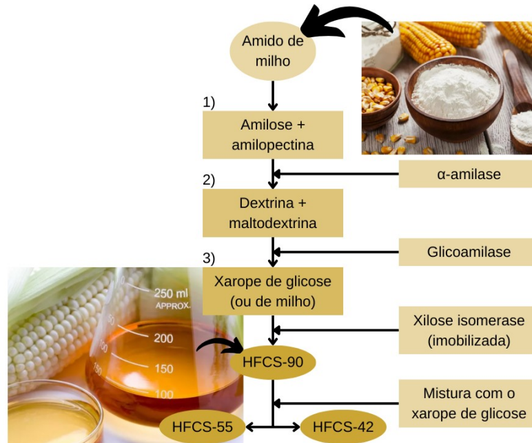
Figura 3 – Produção de HFCS em três etapas
