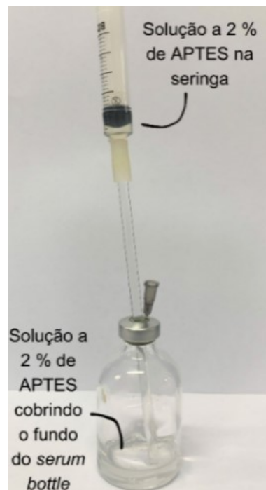
Figura 17 – Microrreator capilar conectado à seringa com tubo de silicone após inserção da solução a 2% de APTES
