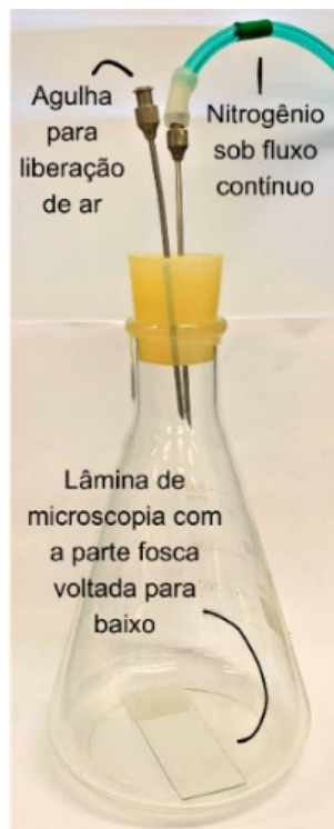
Figura 13 – Sistema inerte montado para a lâmina de microscopia
