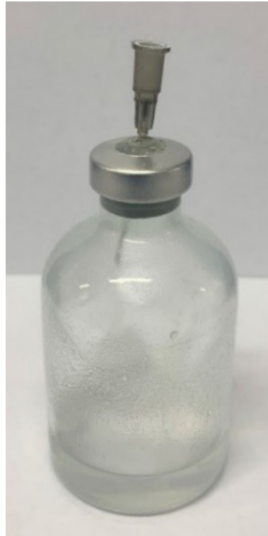
Figura 10 – Serum bottle contendo a sílica amorfa e solução a 2% de APTES
