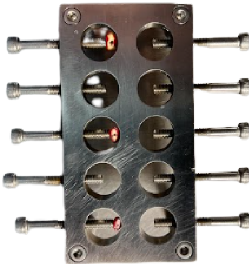
FIGURA 8: blocos dos três terços dispostos em plataforma metálica estéril
