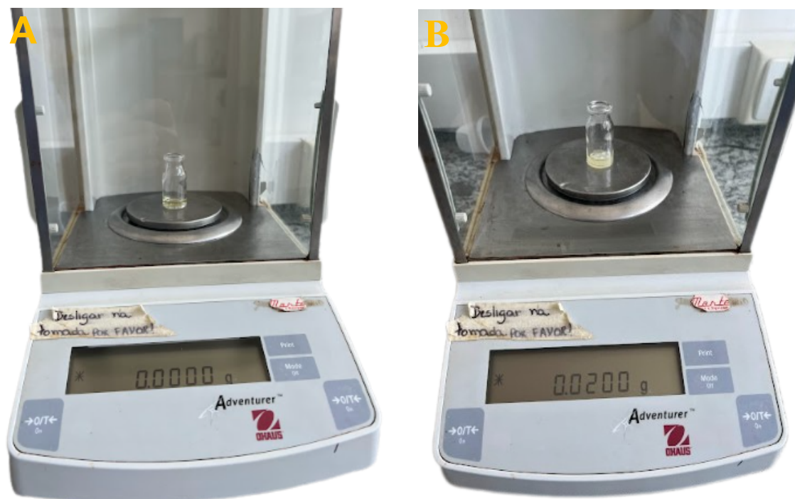
FIGURA 14: Pesagem. A: tara – referente ao frasco contendo 1000 ul de BHI caldo; B: Pesagem do pó dentinário coletado.
