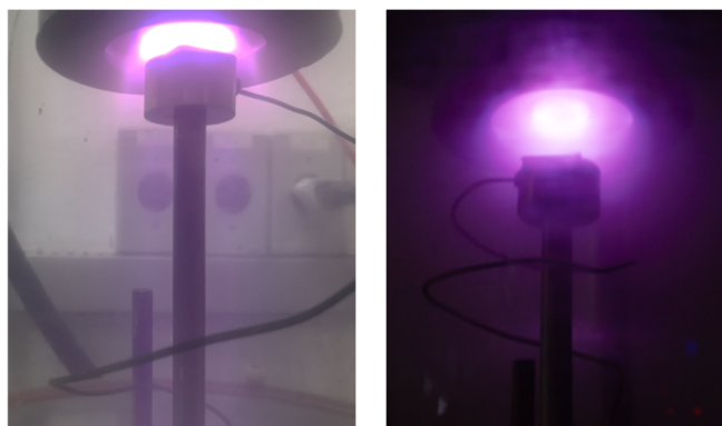
Figura 21 – Testes de ignição da descarga luminescente
