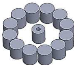
Figura 73 – Combinação de ímãs permanentes utilizada no dispositivo de magnetron sputtering
