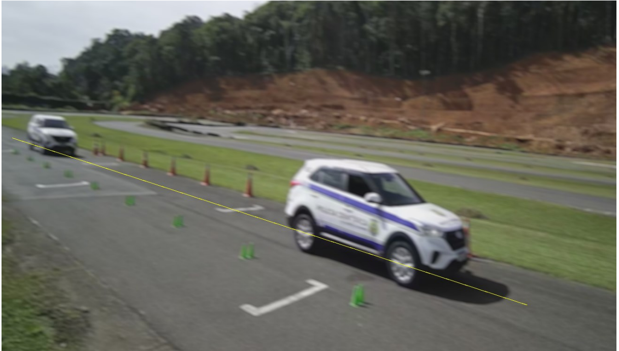
Figura 42 – Sobreposição de quadros referente à captura da passagem #04 com a câmera VIP 1130 B G3 após processo de remoção de distorção, manipulação e adição de reta colinear aos centros de eixo do veículo.
