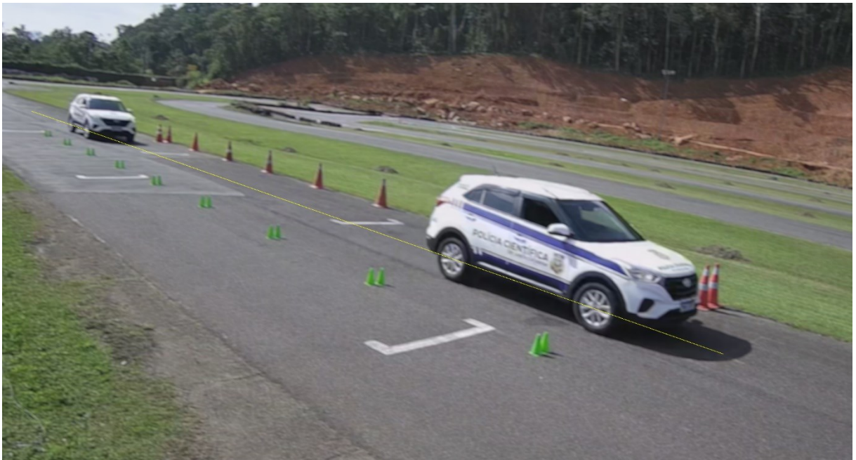
Figura 47 – Sobreposição de quadros referente à captura da passagem #05 com a câmera VIP 5550 Z IA após processo de remoção de distorção, manipulação e adição de reta colinear aos centros de eixo do veículo.
