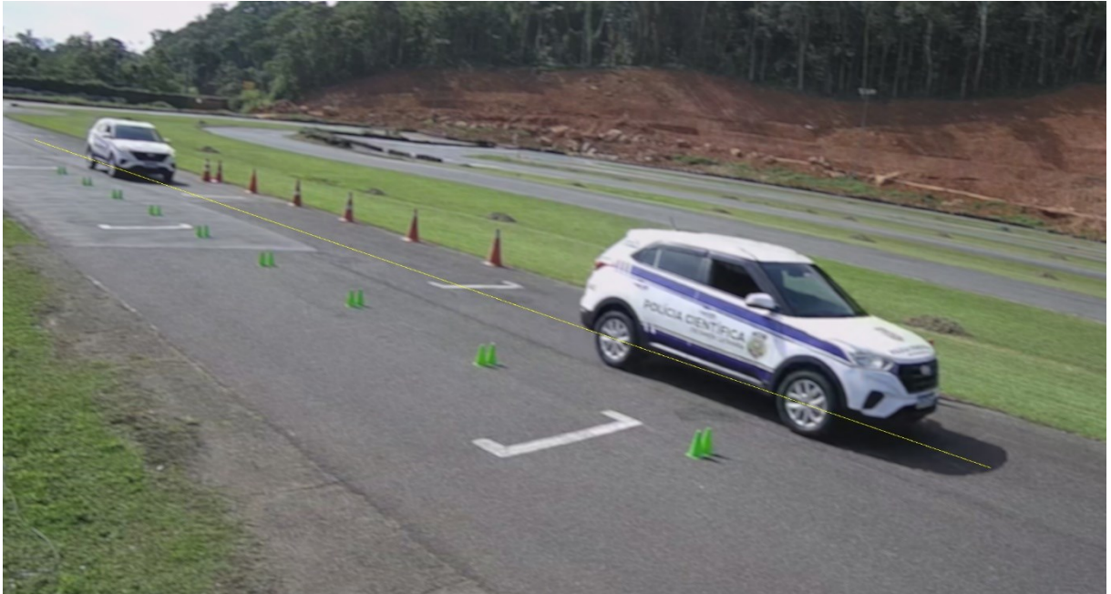
Figura 38 – Sobreposição de quadros referente à captura da passagem #02 com a câmera VIP 5550 Z IA após processo de remoção de distorção, manipulação e adição de reta colinear aos centros de eixo do veículo.
