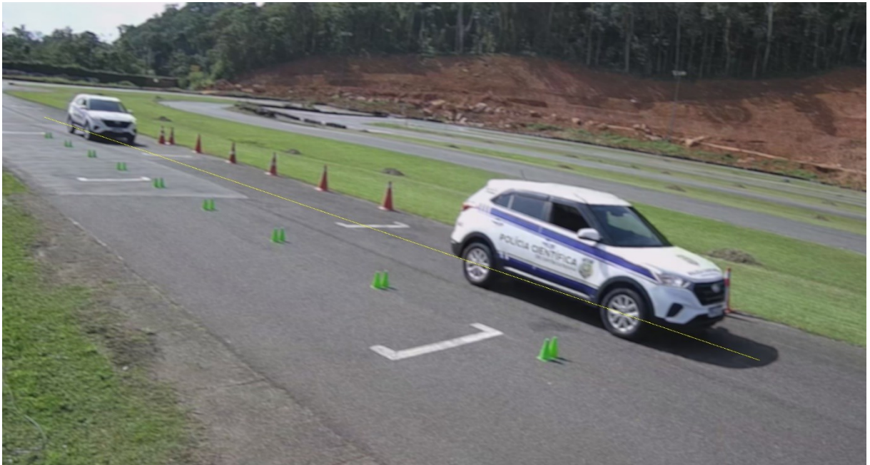
Figura 35 – Sobreposição de quadros referente à captura da passagem #01 com a câmera VIP 5550 Z IA após processo de remoção de distorção, manipulação e adição de reta colinear aos centros de eixo do veículo.
