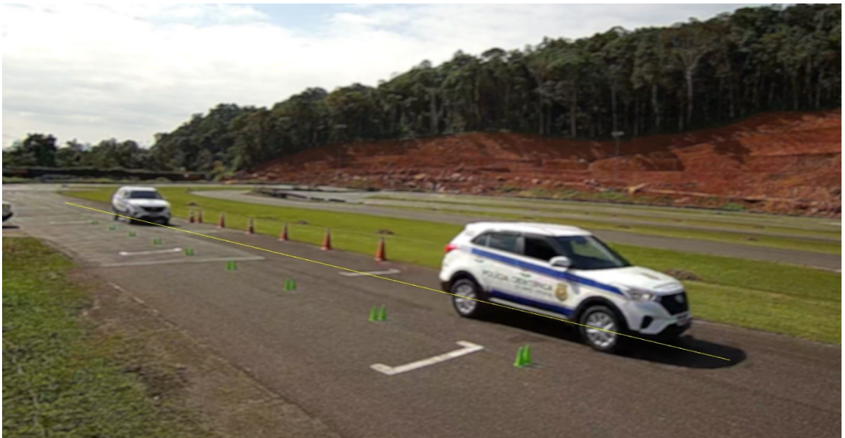
Figura 43 – Sobreposição de quadros referente à captura da passagem #04 com a câmera VIP 3260 Z G2 após processo de remoção de distorção, manipulação e adição de reta colinear aos centros de eixo do veículo.
