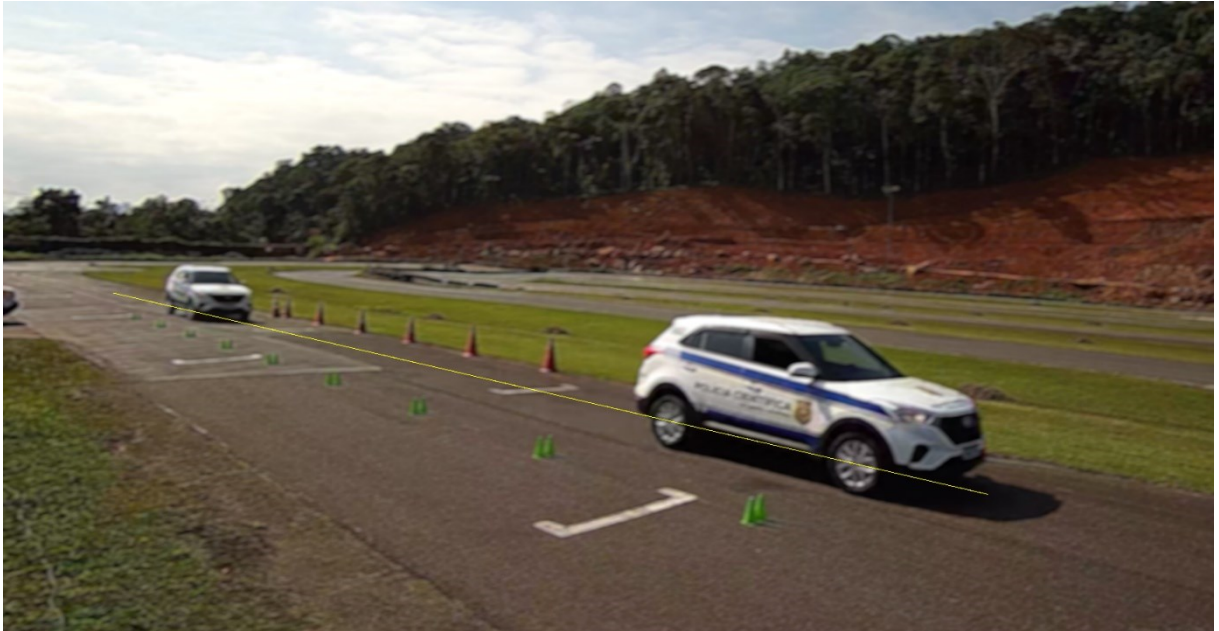
Figura 34 – Sobreposição de quadros referente à captura da passagem #01 com a câmera VIP 3260 Z G2 após processo de remoção de distorção, manipulação e adição de reta colinear aos centros de eixo do veículo.
