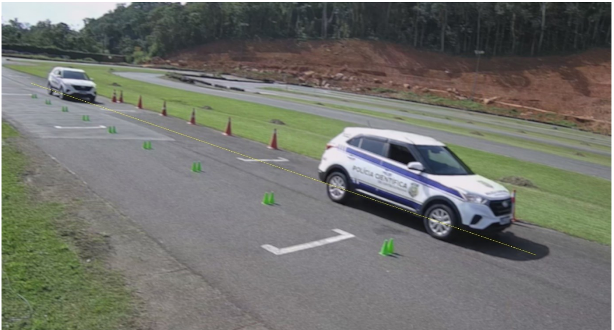
Figura 14 – Sobreposição de quadros referente à captura da passagem #01 com a câmera VIP 5550 Z IA após processo de remoção de distorção, manipulação e adição de reta colinear aos centros de eixo do veículo.
