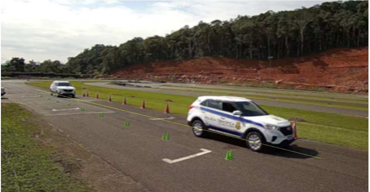
Figura 46 – Sobreposição de quadros referente à captura da passagem #05 com a câmera VIP 3260 Z G2 após processo de remoção de distorção, manipulação e adição de reta colinear aos centros de eixo do veículo.
