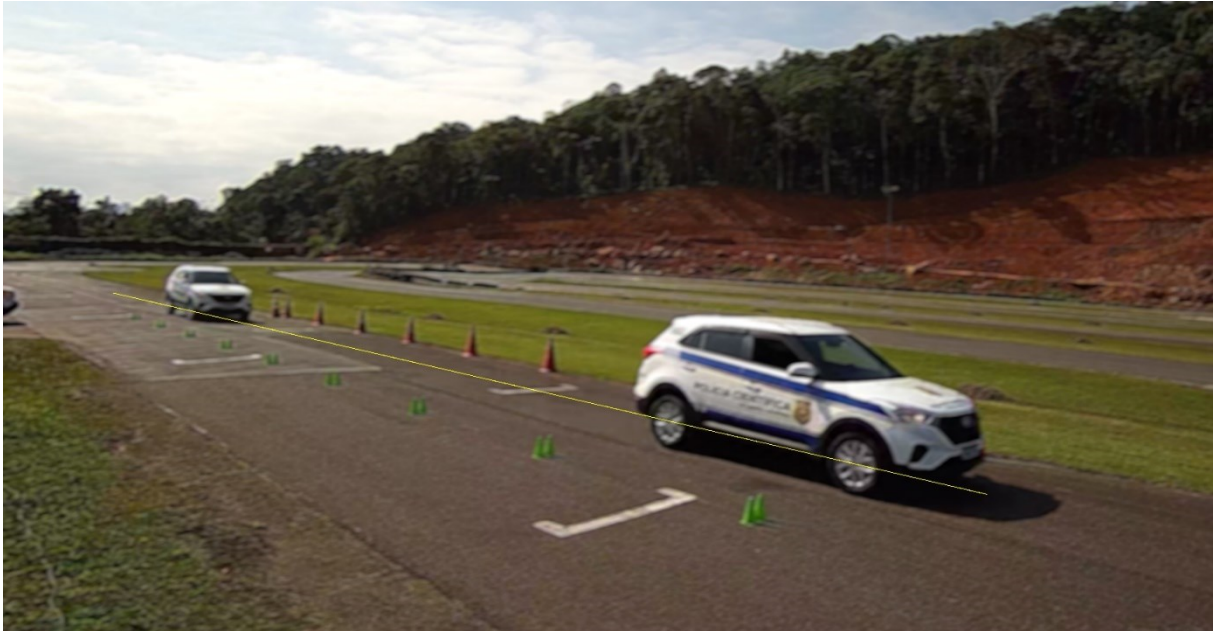
Figura 13 – Sobreposição de quadros referente à captura da passagem #01 com a câmera VIP 3260 Z G2 após processo de remoção de distorção, manipulação e adição de reta colinear aos centros de eixo do veículo.
