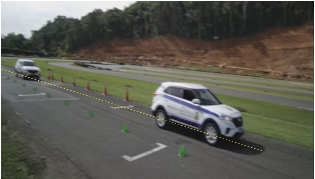
Figura 39 – Sobreposição de quadros referente à captura da passagem #03 com a câmera VIP 1130 B G3 após processo de remoção de distorção, manipulação e adição de reta colinear aos centros de eixo do veículo.
