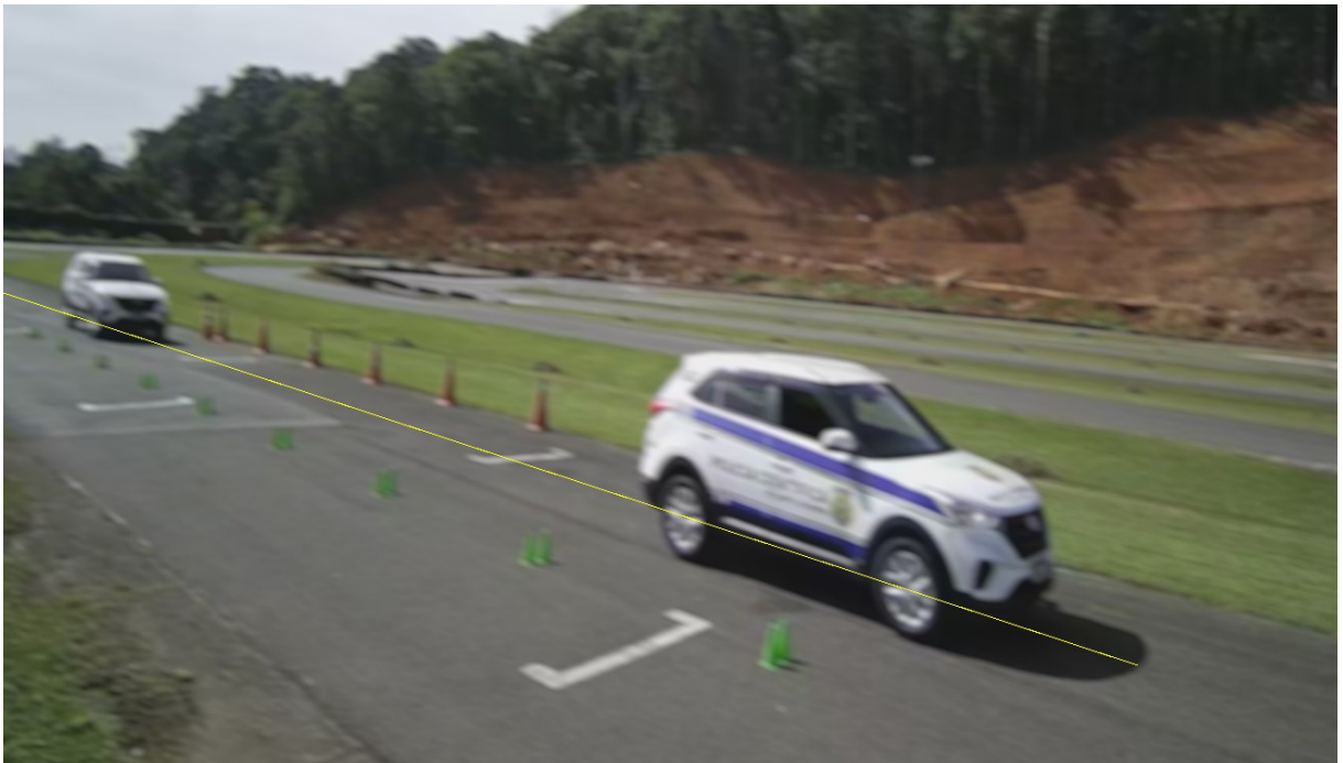
Figura 45 – Sobreposição de quadros referente à captura da passagem #05 com a câmera VIP 1130 B G3 após processo de remoção de distorção, manipulação e adição de reta colinear aos centros de eixo do veículo.
