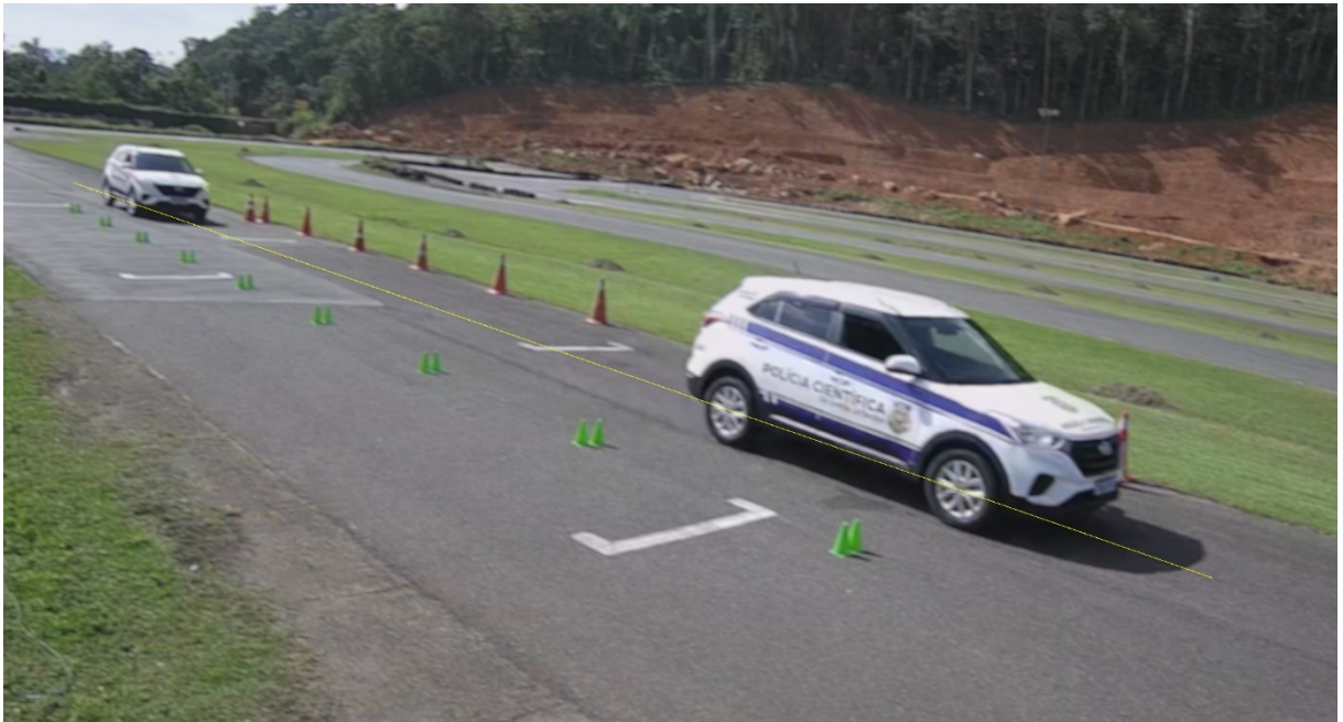
Figura 44 – Sobreposição de quadros referente à captura da passagem #04 com a câmera VIP 5550 Z IA após processo de remoção de distorção, manipulação e adição de reta colinear aos centros de eixo do veículo.
