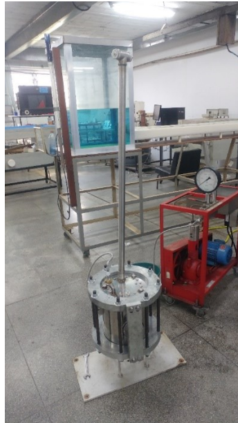
Figura 12 – Teste hidrostático da câmara de ebulição
