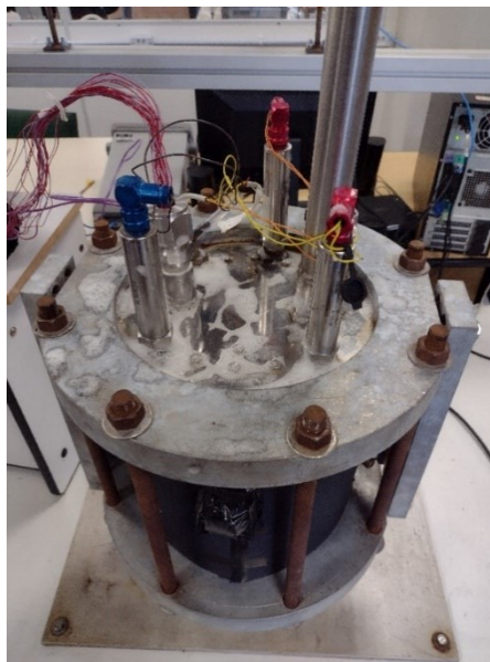
Figura 18 – Verificação de vazamentos na câmara com espuma de detergente
