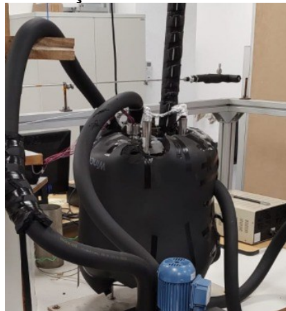
Figura 13 – Câmara de ebulição com o isolante de espuma elastomérica
