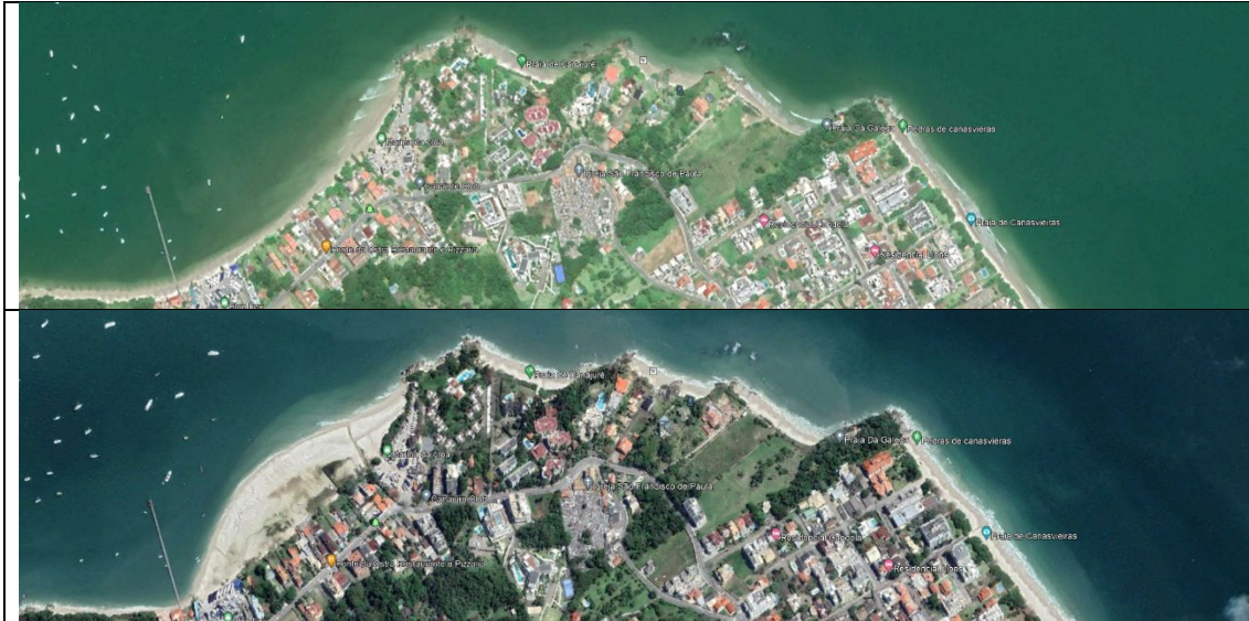
Figura 6. Abrangência regional das obras de aterro em praias. Praia de Canajurê (à esquerda), antes (11/2018) e após (10/2022) o aterro da Praia de Canasvieira (à direita), realizado em fevereiro de 2020. As imagens evidenciam que a Praia de Canajurê também foi aterrada, o que não foi previsto no EAS.
