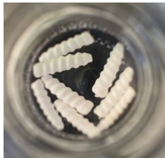
Figura 28 - Parafusos 29º dia de biodegradação parafusos inchados
