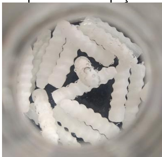
Figura 27 - Parafusos 5º dia de biodegradação, coloração de aspecto esbranquiçado
