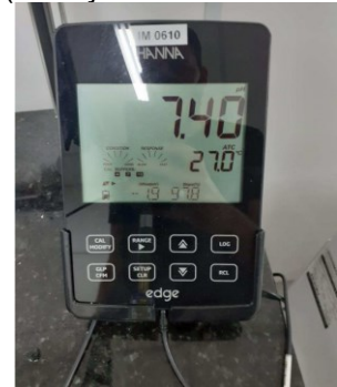
Figura 26 - Medições pHmetro (condições iniciais do teste)
