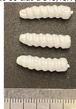
Figura 32 - Pós biodegradação in vitro de 30 dias à 315,15K (42 °C)
