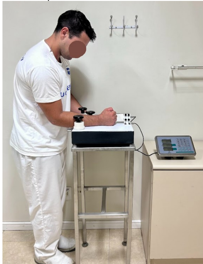
Figura 26 – Realização da avaliação de força de flexão de punho utilizando a plataforma dinamométrica
