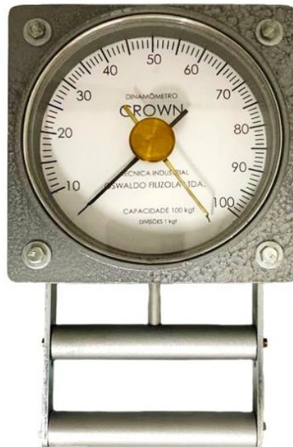
Figura 21 – Dinamômetro da marca Crown que foi utilizado para avaliação da força de prensão manual dos trabalhadores
