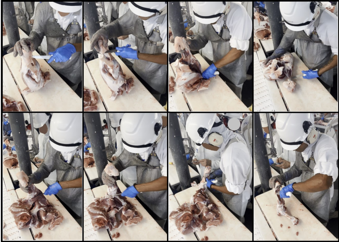
Figura 35 – Sequência fotográfica do procedimento de desossa do osso fêmur realizada pelo trabalhador
