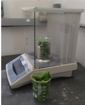
A – Balança de precisão para pesagem de amostras.
