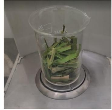
C – Peso seco de amostra após 5 dias em estufa a 60°C.
