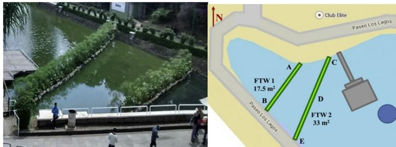
Quadro 8 – Arranjos de CFWs com aplicações em escala real para tratamento de águas pluviais urbanas (*continuação*).
