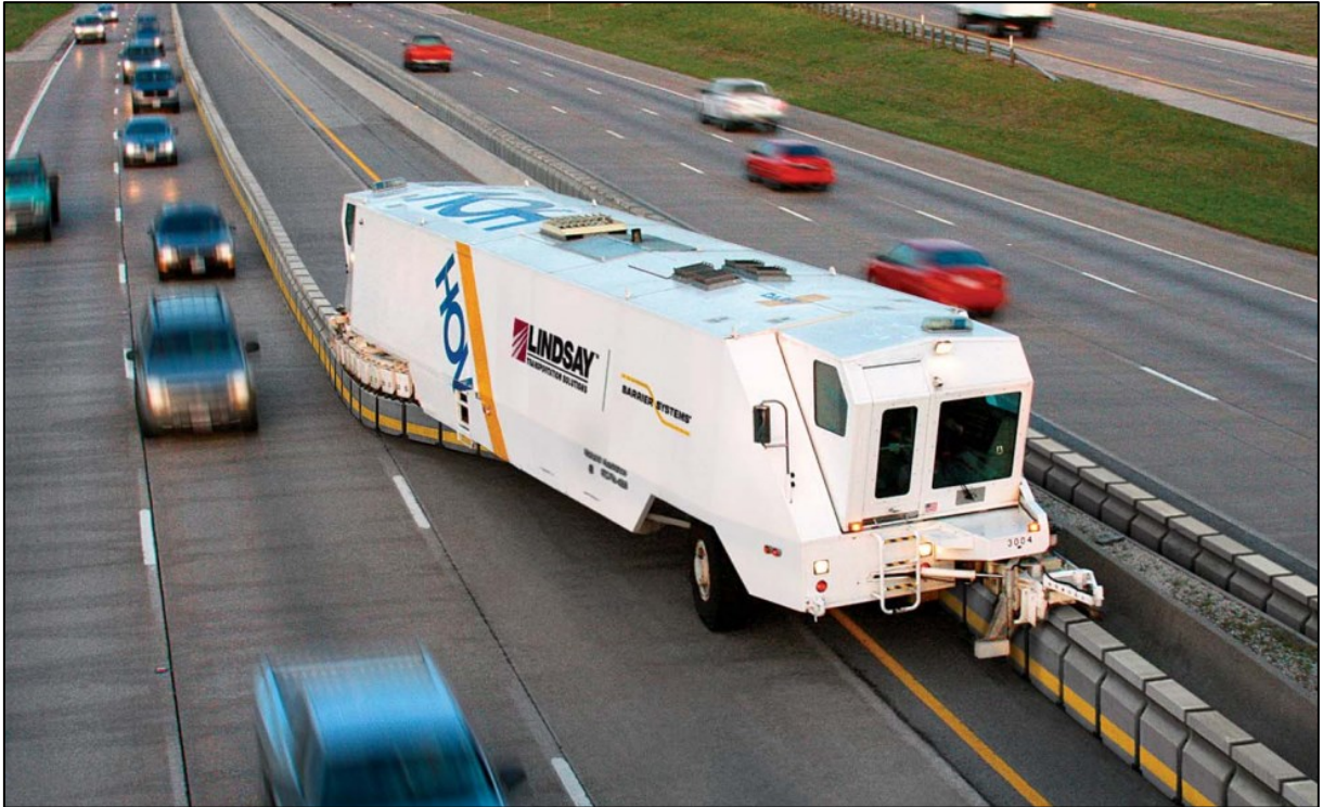
Figura 12 – Sistema de moveable barriers em operação.
