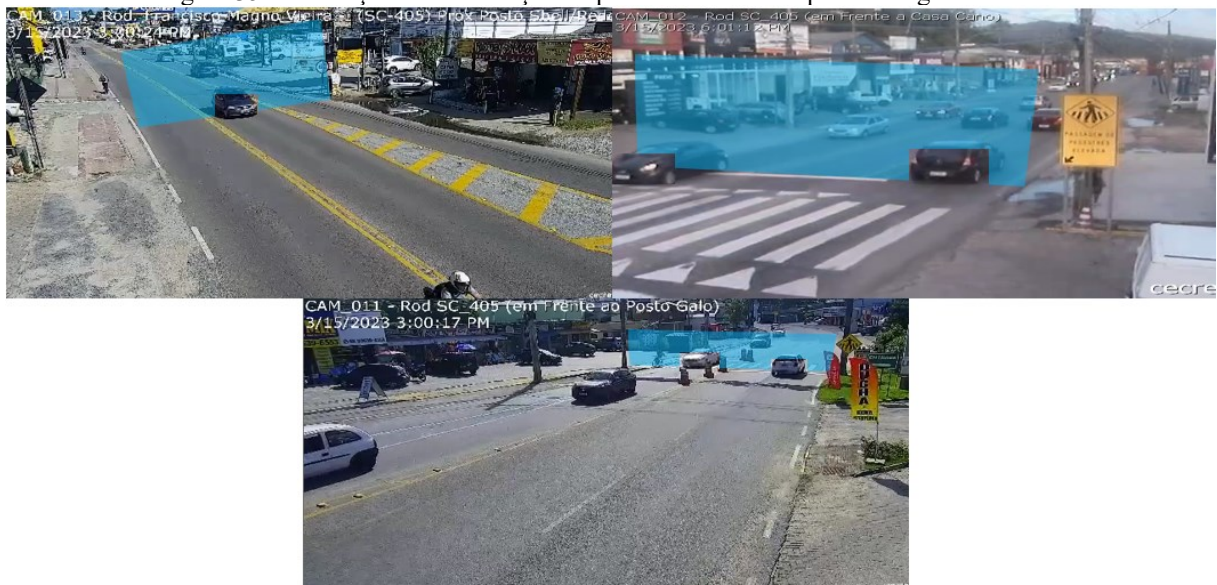
Figura 35 – Ilustração da delimitação do plano de referência para contagem veicular.
