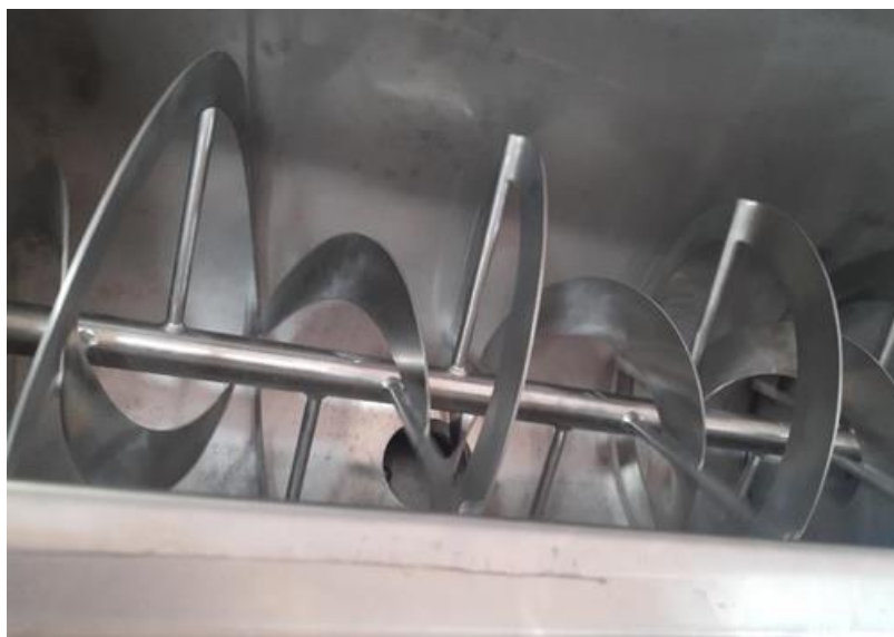
Figura 6. Condicionador Andritz CM: (a) vista externa; (b) vista interna.
