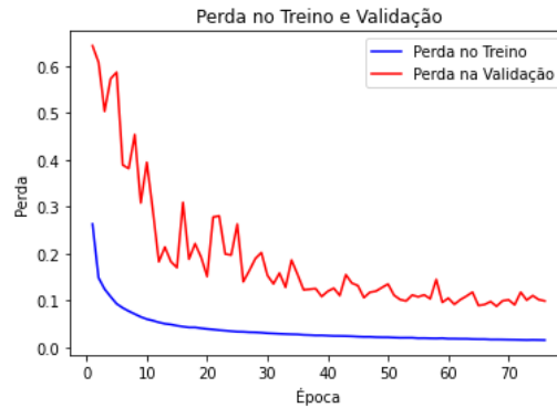
Figura 23 – Curva da função perda de dados no treino e validação no Kvasir-SEG com a rede MobileNetV2+U-Net.
