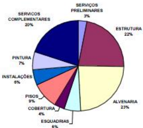
Figura 5.4: Distribuição percentual de Energia por partes da edificação do Modelo 1
