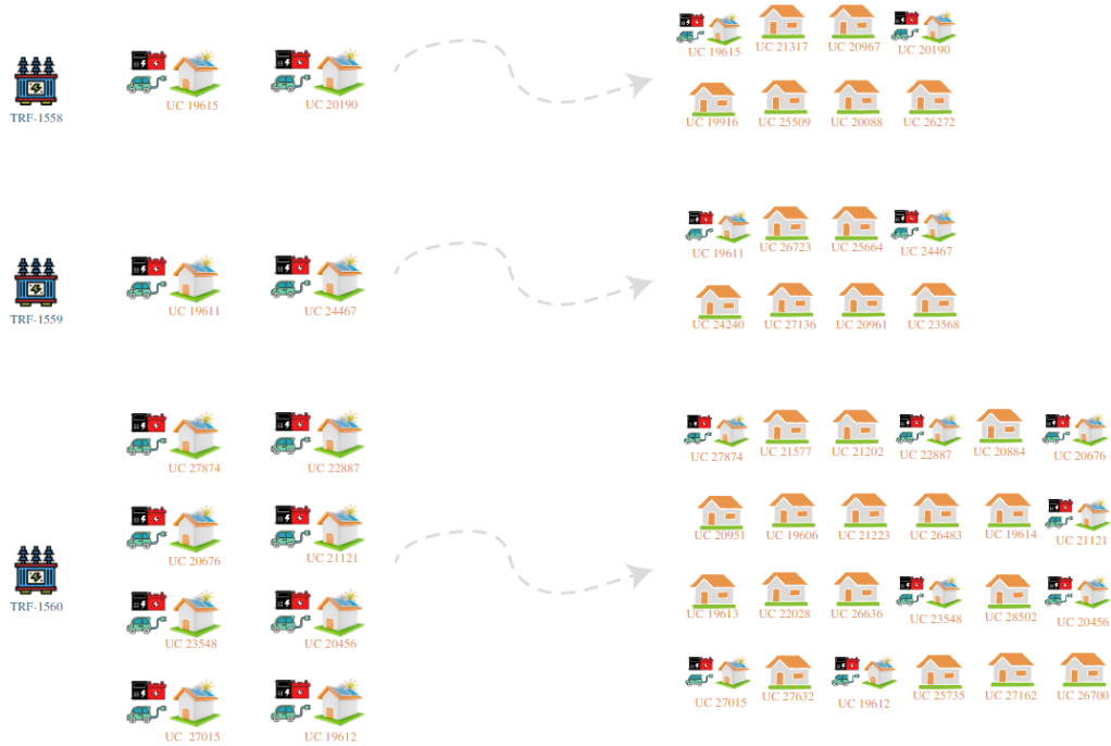
Figura 20 – Configuração com 30% de SFCR, veículo elétrico e bateria integrada ao inversor do terceiro cenário.
