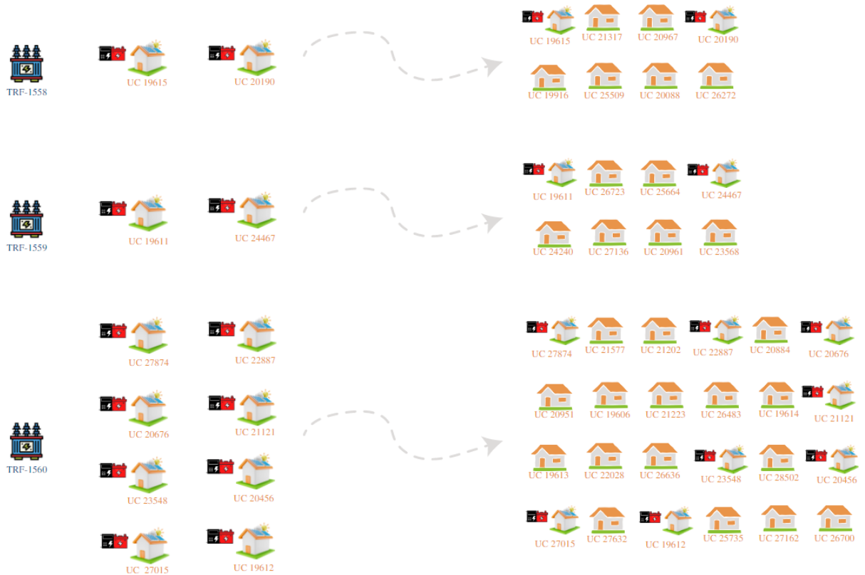
Figura 18 – Configuração de 30% de SFCR com bateria integrada ao inversor do segundo cenário.
