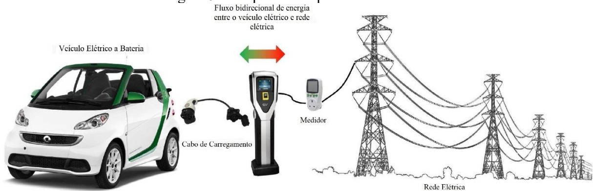
Figura 9 – Esquema simplificado do V2G.
