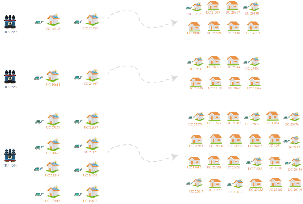
Figura 19 – Configuração com 30% de SFCR e veículo elétrico do terceiro cenário.
