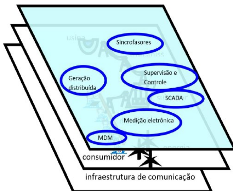
Figura 6 – Infraestrutura de supervisão e medição
