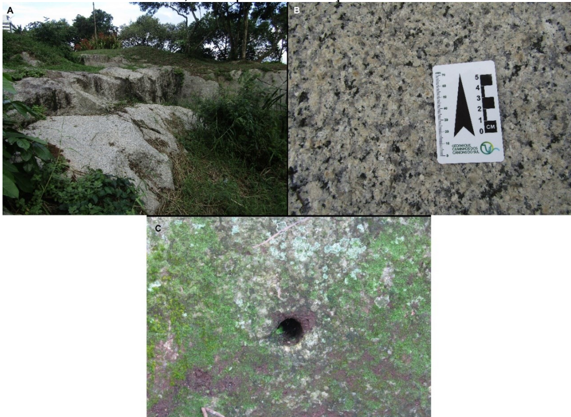
Figura 10 - Foto A: Afloramentos de rochas dentro da área do Parque da Luz; Foto B: Granito Ilha; Foto C: Buracos encontrados em algumas rochas na área de estudo, feitos para dinamitação das rochas.
