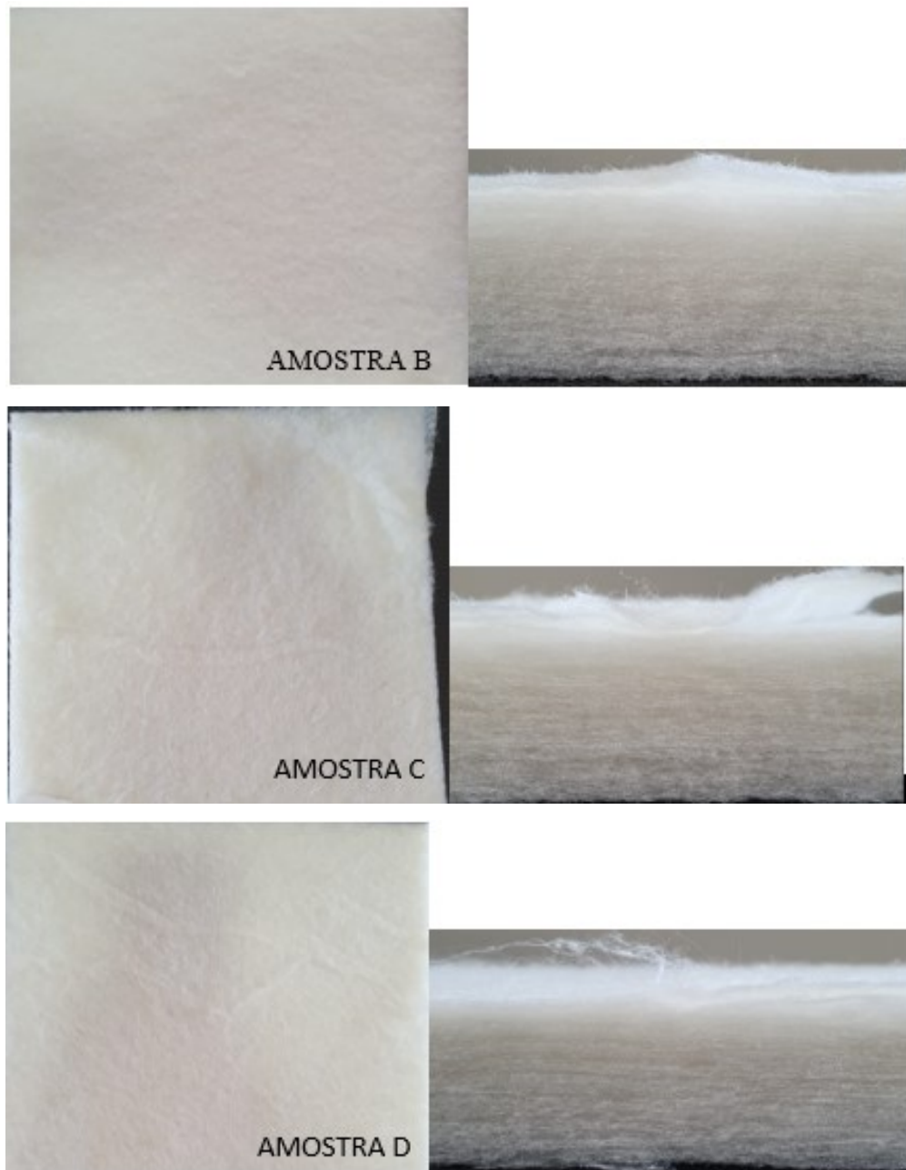
Figura 21 – Aspecto macroscópico da superfície e da seção transversal das amostras B, C e D
