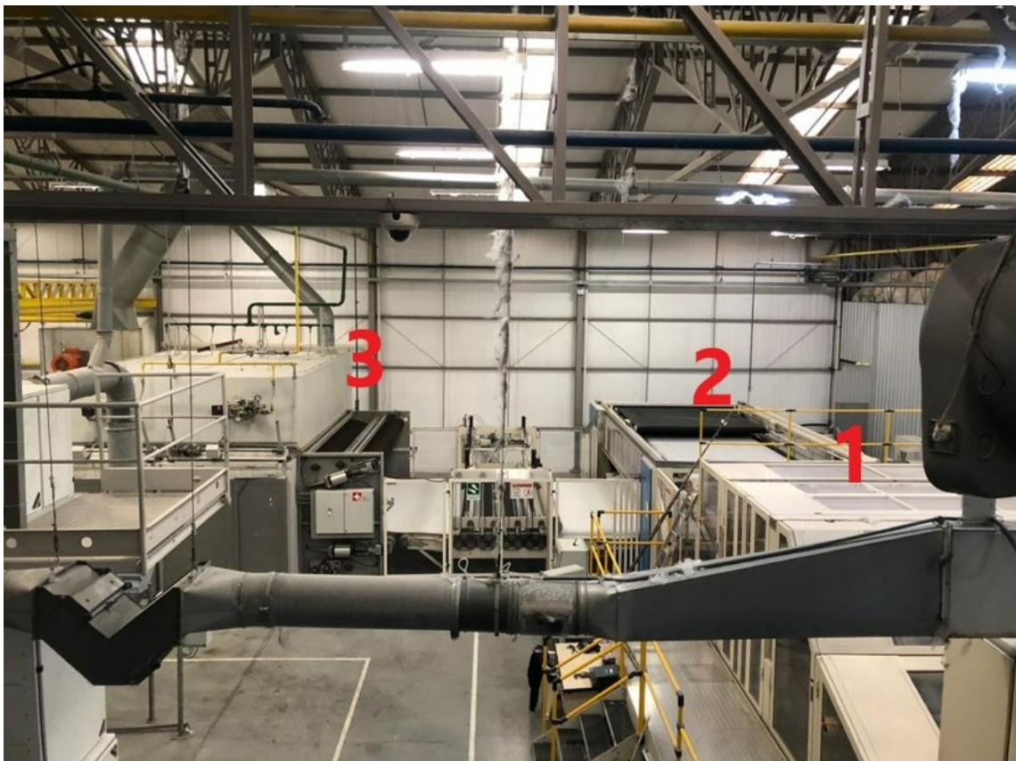
Figura 10 – Equipamentos utilizados para a produção do nãotecido: 1) carda; 2) dobrador de véus e 3) forno para consolidação
