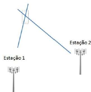
Fig. 4.6– Determinação da posição da estação móvel utilizando o AoA em duas estações.
