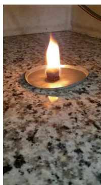
Figura 7: Pellet após ser submetido a uma fonte de calor. Fonte: Própria
