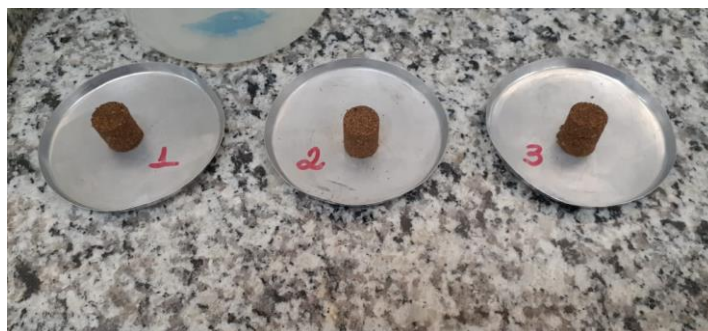
Figura 5: Pellets utilizados no cálculo do poder calorífico. Fonte: Própria.
