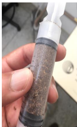
Figura 3: Compactação do composto, juntamente com os aditivos propostos, para formação dos pellets. Fonte: Própria.
