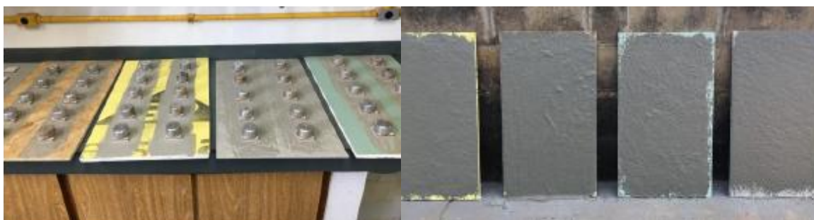
Figura 1: Conjuntos produzidos (parte A- Argamassa Industrializada; parte B – uso de chapisco anterior a argamassa tradicional). Fonte: elaborado pelos autores.
