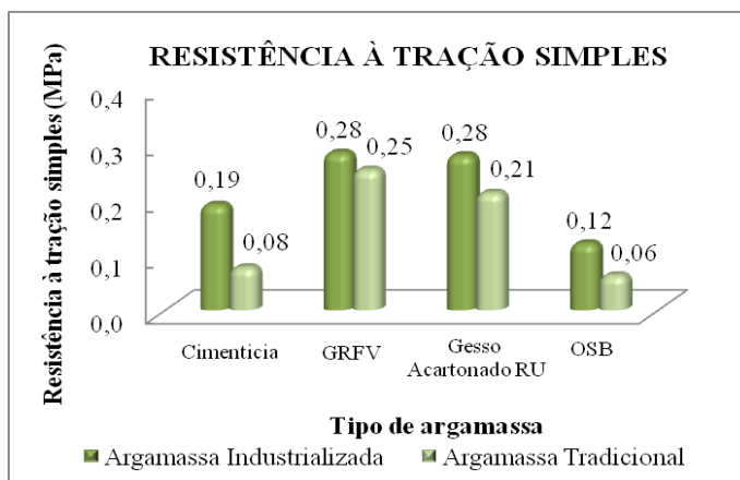
Gráfico 01: Resistência de aderência à tração simples. Fonte: elaborado pelos autores.
