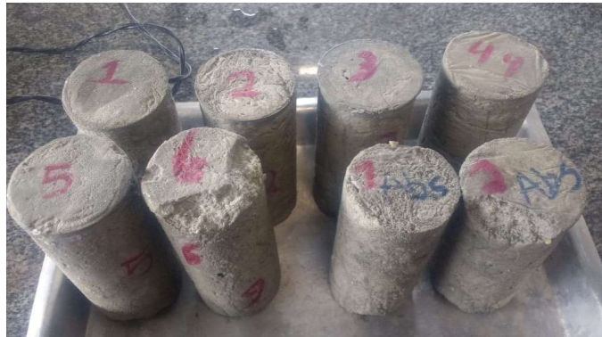
Figura 1: Corpos de prova confeccionados com resíduo de casca de ovo. Fonte: Elaborado pelos autores.
