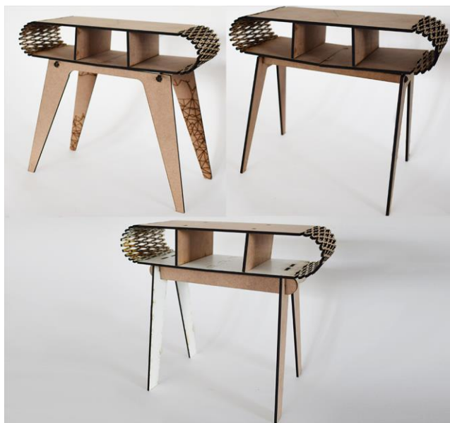
Figura 20: Alternativa escolhida prototipada em corte laser. Fonte: elaborado pelos autores.
