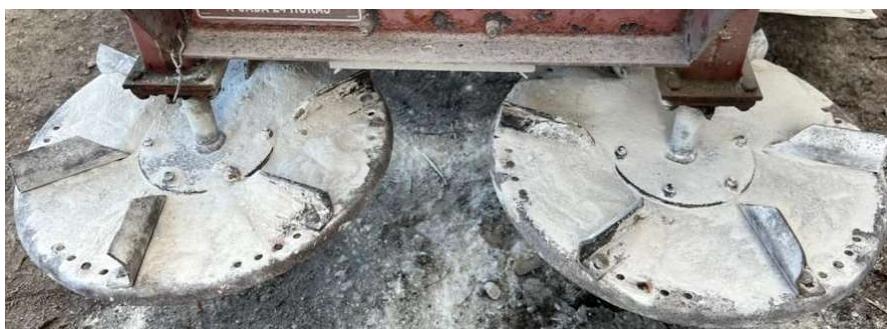
Figura 34 – Ajuste T2: aletas posicionadas nas extremidades opostas ao sentido de rotação dos discos
