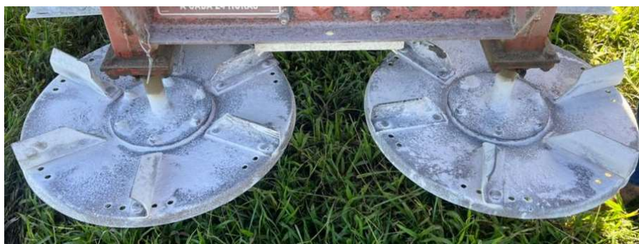
Figura 23 - Ajuste T1: aletas posicionadas no furo central
