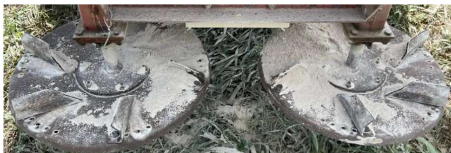
Figura 45 - Ajuste T3: aletas posicionadas nas extremidades no sentido de rotação dos discos
